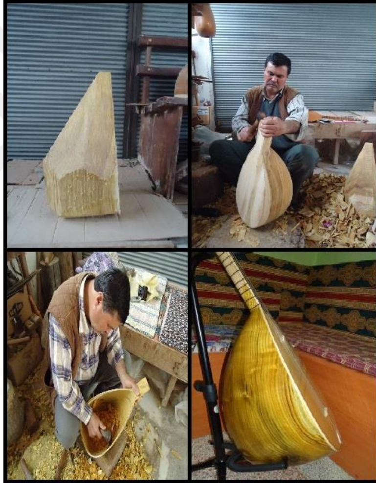
Resim 1.2. Oyma-Yarma Teknenin Yapılışı ( http://www.ozkansazevi.com )
