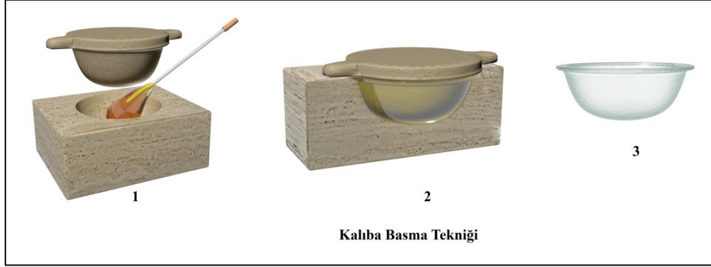
Çizim 11: Kalıba Basma Tekniği Uygulaması (Çizim Arkeolog K. Eker, Canav 2013'ten faydalanılmıştır).
