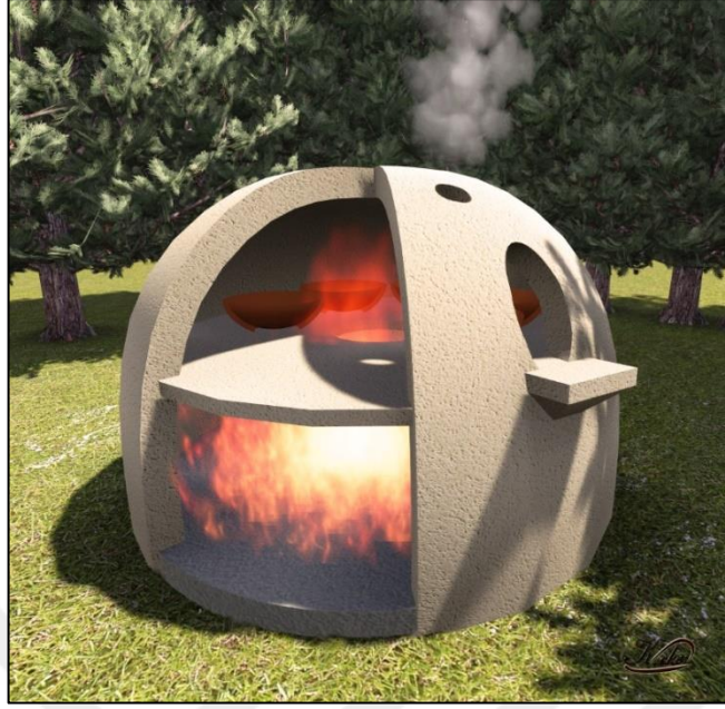
Çizim 3: Potalı Cam Fırını Kesit Restitüsyonu (Eker, 2014, Çizim 2)
