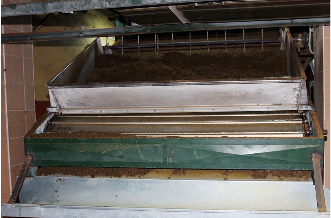
Resim 4.4. Çay İmalatında Kurutma / Fırınlama Aşaması
