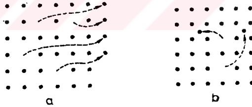
Şekil 2.3. a) Schottky kusuru, b) Frenkel kusuru.
