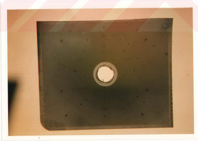
Şekil 3.17. TlInSe 2 tek kristalinin (110) yarılm düzlemine dik olarak çekilen geri yansımah Laue x-ışını filmi.
