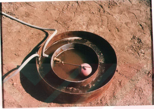
Şekil 3. 5. Arazide yapılan infiltrasyon ölçümünden bir görünüm
