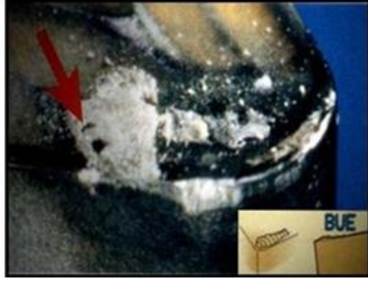
Şekil 4.26. Yapışma ve BUE oluşumu [40].
