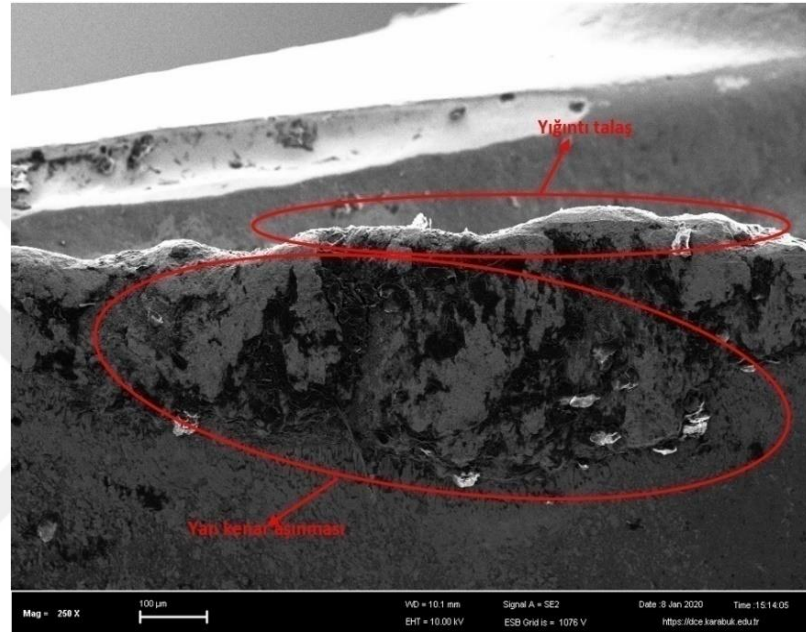
Şekil 6.9. Yığıntı talaş -Yan kenar aşınması SEM görüntüsü.
