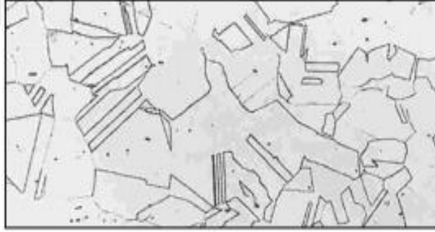
Şekil 3.1. Östenitik paslanmaz çelik mikro yapısı [18].
