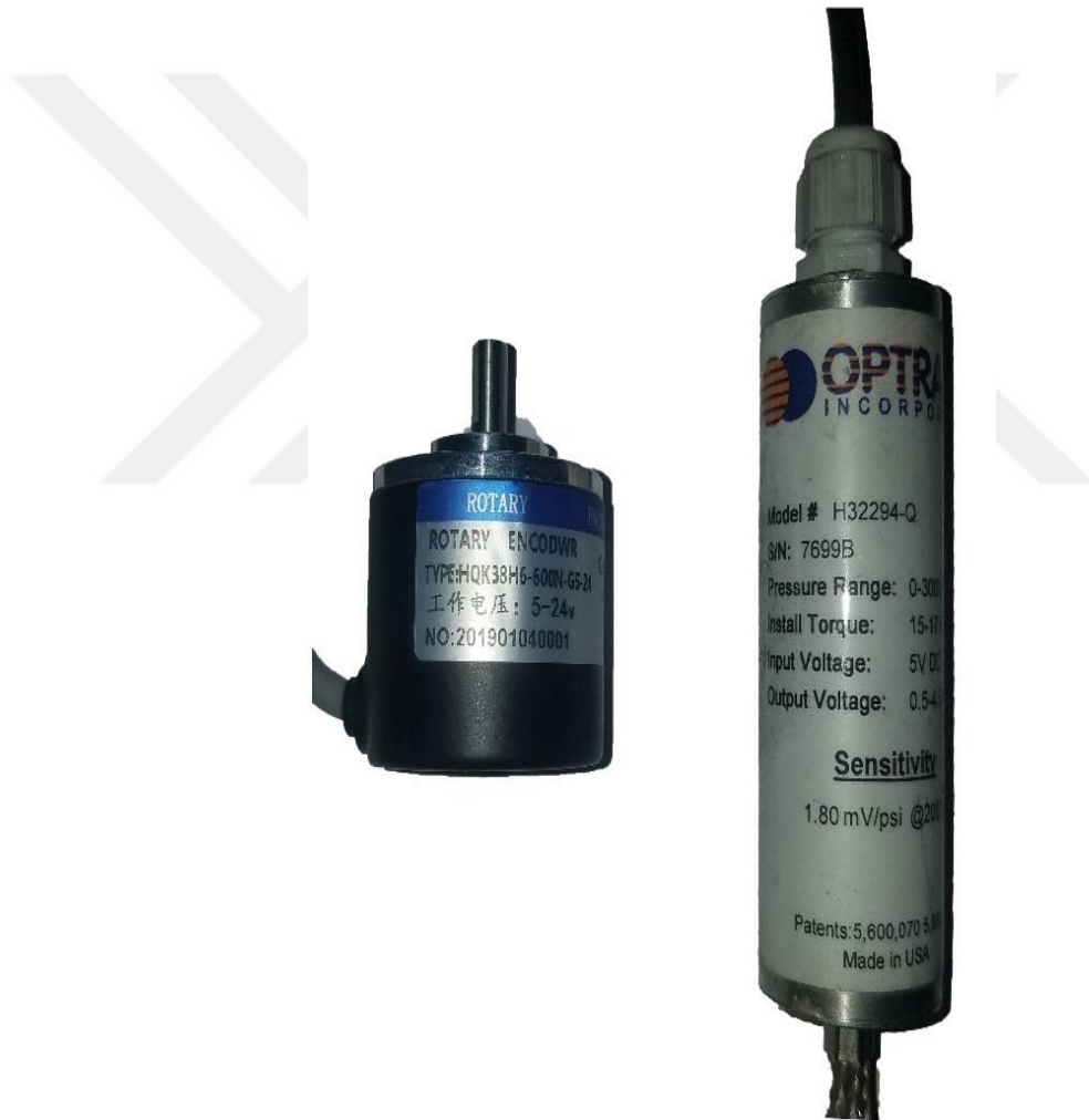
Şekil 5.13. Basınç ve krank açısı sensörlerine ait fotoğraflar.
