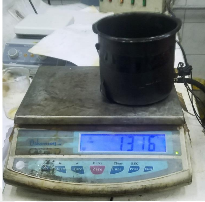
Şekil 5.9. Yakıt tüketiminin ölçülmesi.
