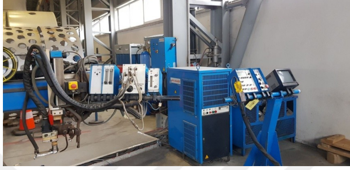
Şekil 3.1. Birleştirilmesinde kullanılan plazma ark kaynak makinesi donanımı.
