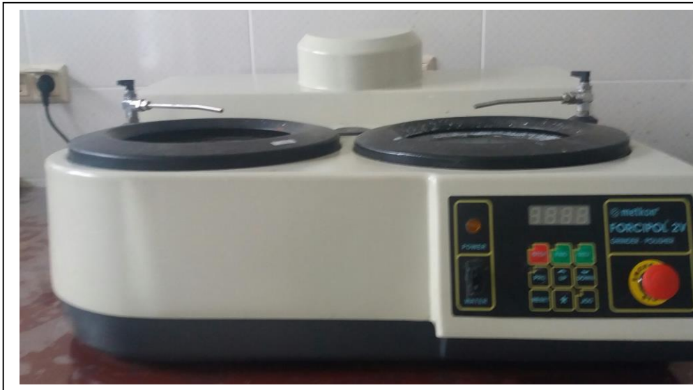
Şekil 5.4. Deneyde kullanılan zımparalama ve parlatma cihazı.
