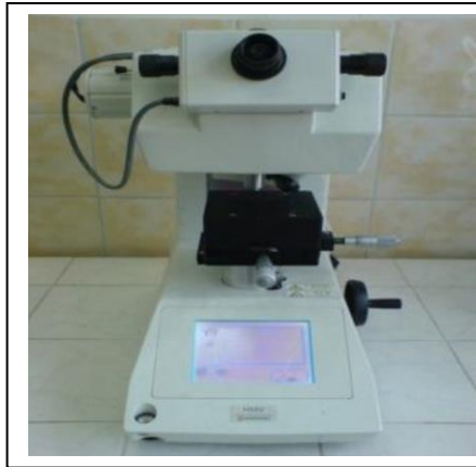
Şekil 5.9. Deneyde kullanılan sertlik ölçüm cihazı.
