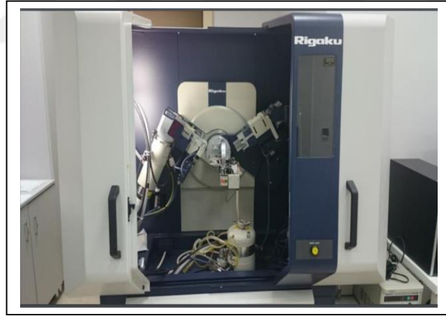
Şekil 5.14. Biyoaktivite deneylerinde kullanılan XRD cihazı.
