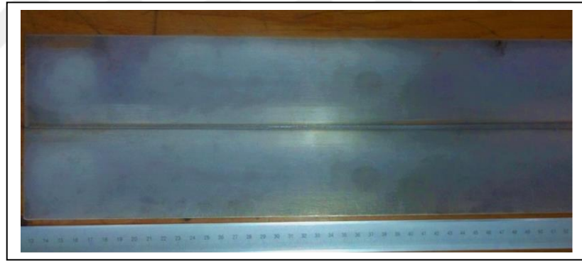
Şekil 5.2. CO 2 lazer kaynaklı Ti6Al4V birleştirmesi.
