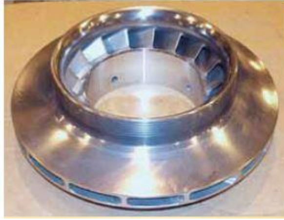
Şekil 4.2. Bandajlı tip (shrouded/close) impeller [26].
