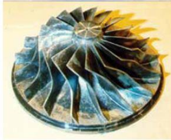
Şekil 4.3. Bandajsız tip (unshrouded/open) impeller [26].
