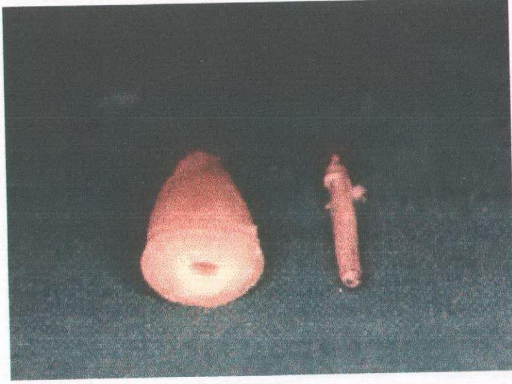
Resim 19 : Çekme kuvveti uygulanması sonucunda diş kanalından ayrılmış post ve dişin görüntüsü.
