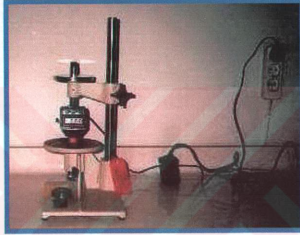
Şekil 24: Sertlik ölçümü yapılan Shore A Durameter test cihazı
