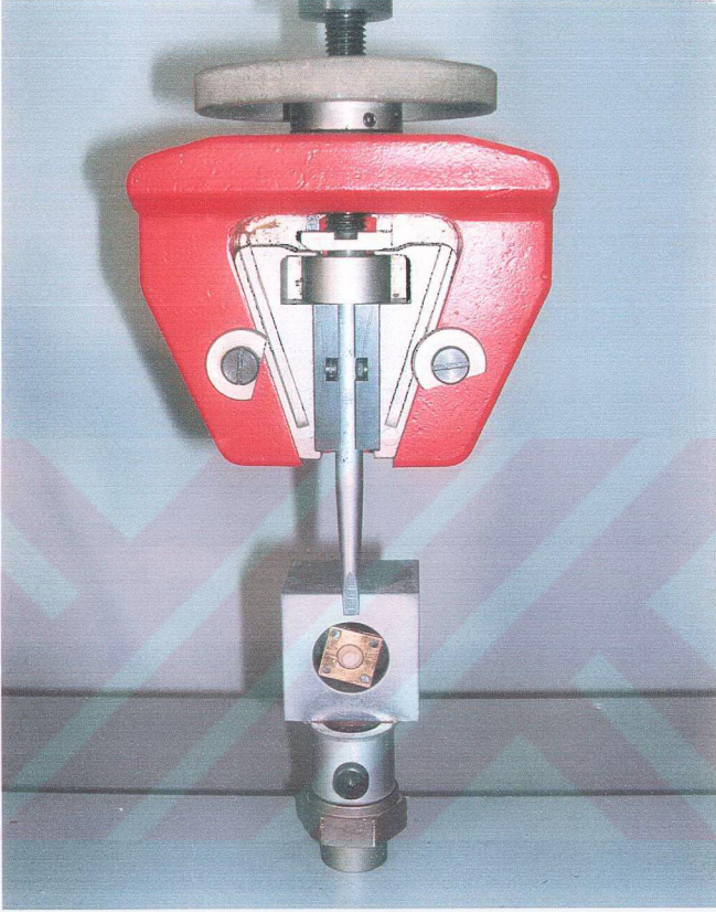
Resim 17: Kesme testi yapılan Testometer micro 500 test aleti' nde örneğin yerleşimi
