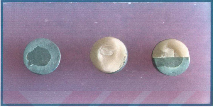
Resim 26: Gruplarda gözlenen bazı kırık tipleri gösterilmiştir. Metal: Adeziv, Porselen: Koheziv, Metal+porselen: Kombine kırık görülüyor.
