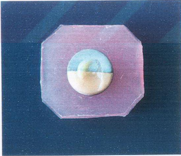
Resim 24, 25: Metal+porselen örnek grubunda görülen kombine tipte kırık
