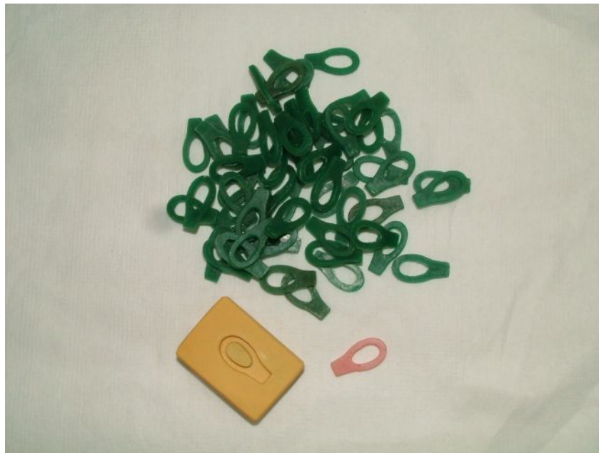
Şekil 46. Tek bir kalıptan oluşturulmuş mum kulplar ve oluşturulmalarında yararlanılan silikon kalıp.
