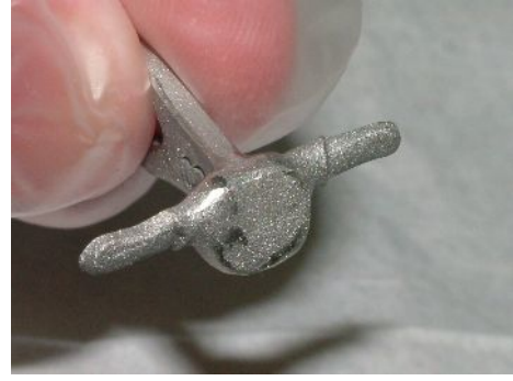
Şekil 77. Modifiye inley tutuculu köprüde kumlanmış siman yüzeyinin görünümü.
