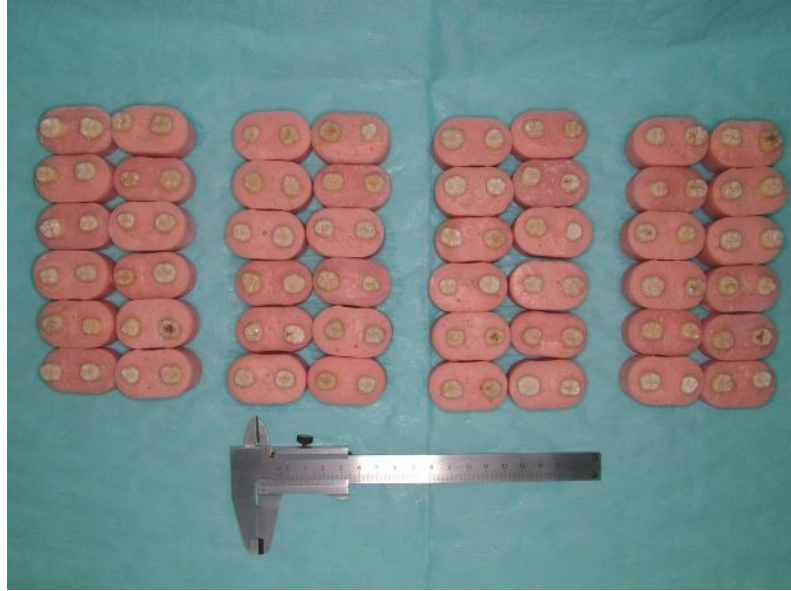
Şekil 15. Akrilik tabanlara diş gömülerek hazırlanmış örneklerin tamamı.
