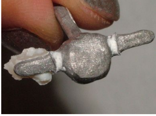
Şekil 101. Adeziv ayrılma sergilemiş köprü tutucu kısımlarının siman yüzeyi görünümü.
