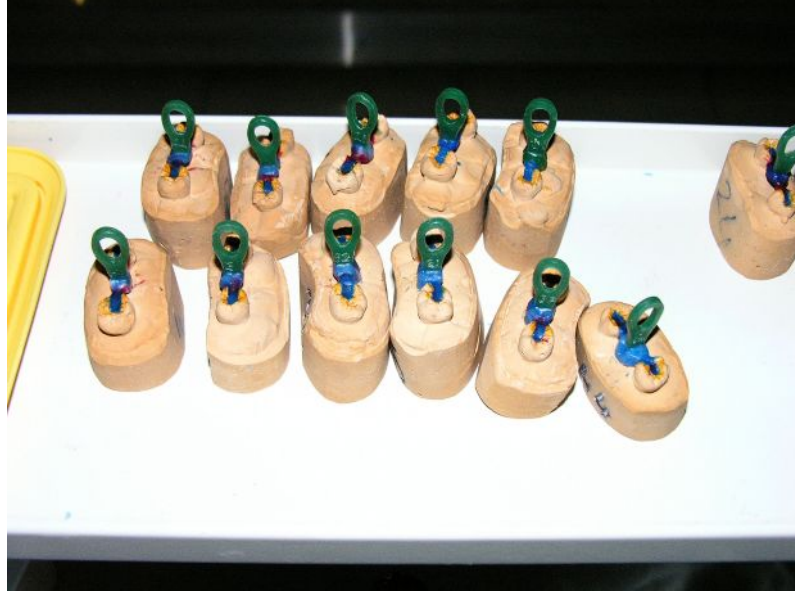
Şekil 47. Döküm işleminin öncesinde modelasyonu tamamlanmış örnekler.
