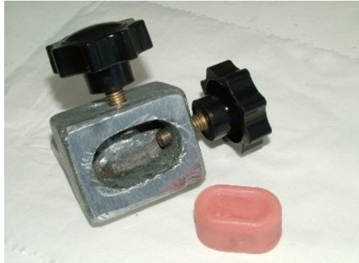
Şekil 94. Döküm yatağı içindeki örneği sıkıştıracak vidaları üzerinde bulunan alt düzeneğin.
