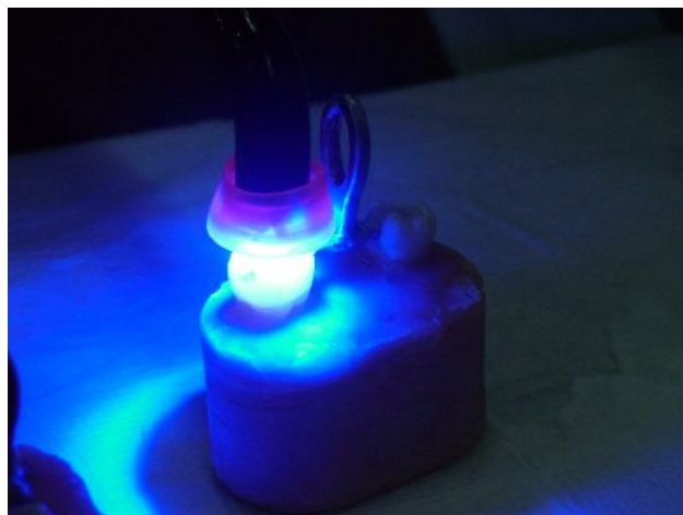
Şekil 86. Işık ile polimerize olan materyallerin mavi ışık kaynağı ile muamele edilmesi.
