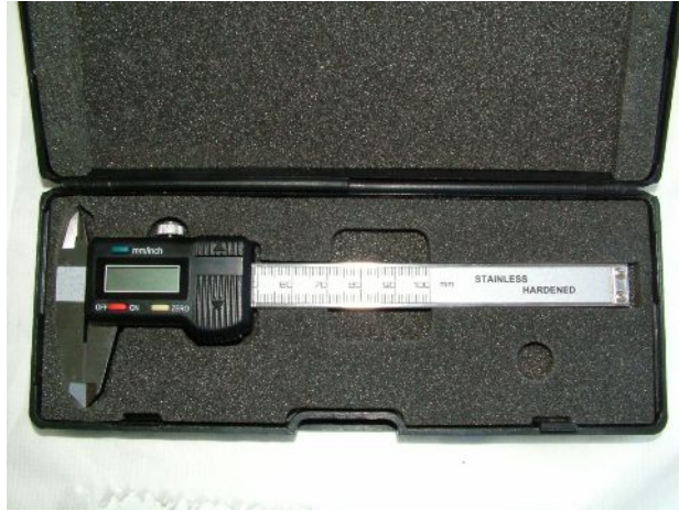
Şekil 58. Alçı modeller ve dökülmüş köprülerin ölçümlerinde kullanılan dijital kumpas.
