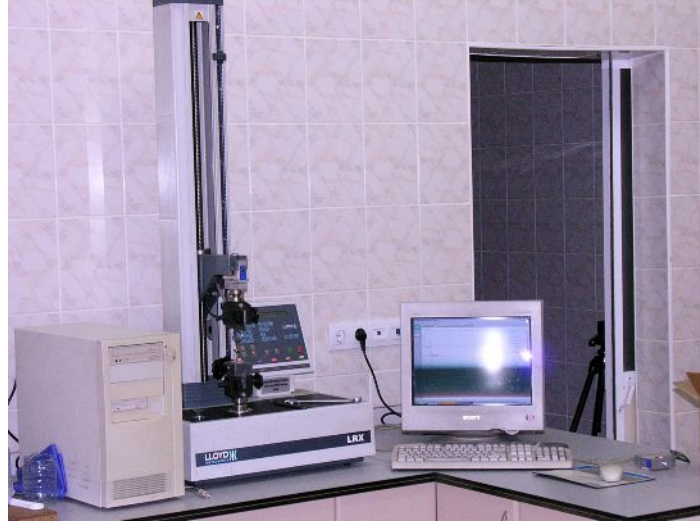
Şekil 96. Çekme deneyinin gerçekleştirildiği tek kolonlu test cihazı.
