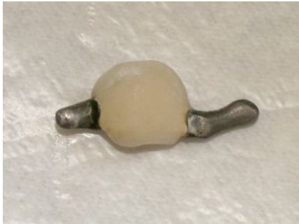
Şekil 113. 2,5 yıl kullanımdan sonra metal-siman aralığında adeziv tip ayrılma sergilemiş inley destekli dizayna sahip köprü. (Vaka: Dr. A. D. İZGİ)
