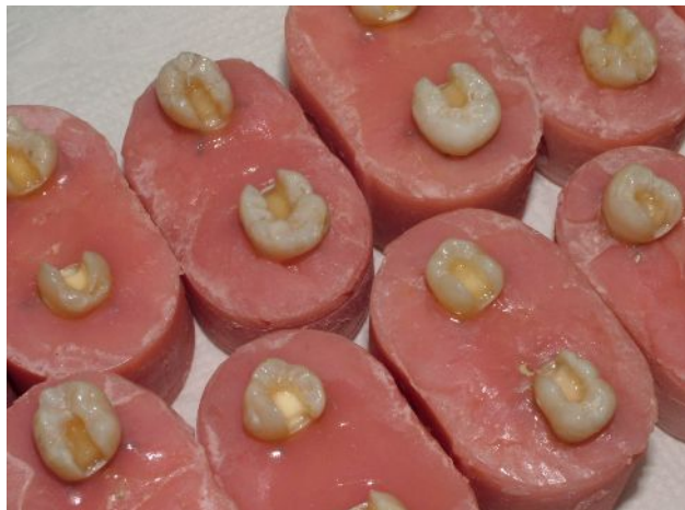
Şekil 83. Mod-G1 ve Gel-G1 gruplarında dentin bağlayıcı ajanı polimerize edilmiş örnekler.
