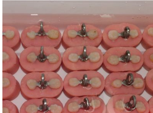
Şekil 91. İzotonik sodyum klorür solüsyonu ortamına bırakılmış simantasyonu tamamlanmış örnekler.
