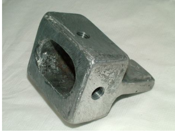
Şekil 93. Örneklerin akrilik tabanlarının içine oturacağı, sıkıştırma vidaları üzerinde bulunmayan alt düzeneğin döküm yatağı.
