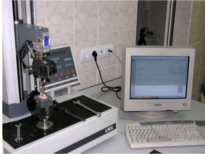
Şekil 97. Bir örneğin test aşaması verilerinin bilgisayar tarafından kaydedilmesi.
