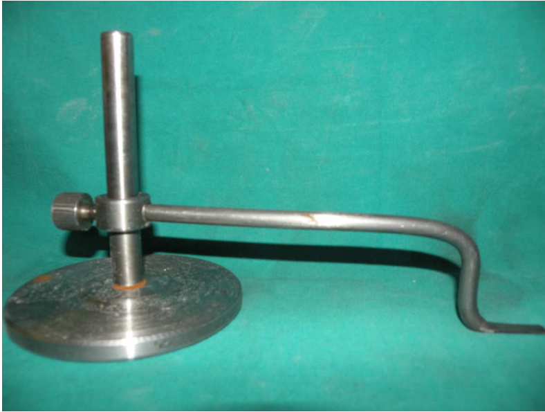
Resim 4: Prepare edilen yüzeylerin yere paralelliğini ölçmekte kullandığımız paralellik ölçer (Tarafımızdan Diyarbakır Sanayi Sitesinde Yaptırılmıştır).
