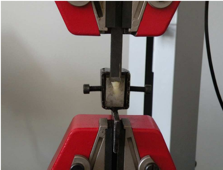
Resim 12: Hazırlamış olduğumuz örneklere Shear testi uygulanması.
