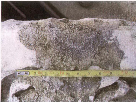
3. Çimento harcı kalıntısından örnek (K13)
