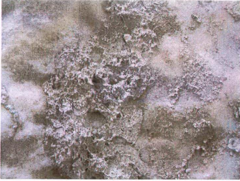
1. Blokların çeşitli yüzeylerindeki kireç harcı kalıntısından örnek (K1)
