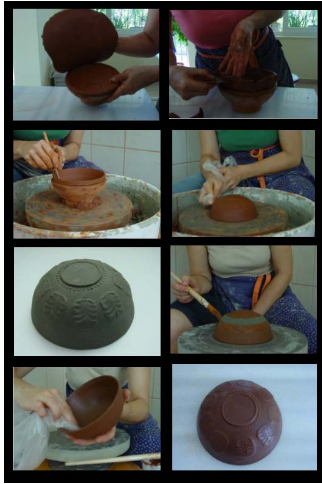
Resim 24 Palmet Damgalı Megara Kâse Yapımı
