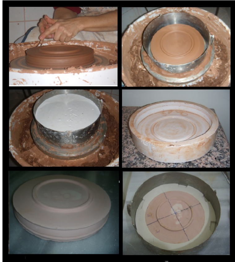
Resim 29 Terra Sigillata Tabak Kalıbı Yapımı
