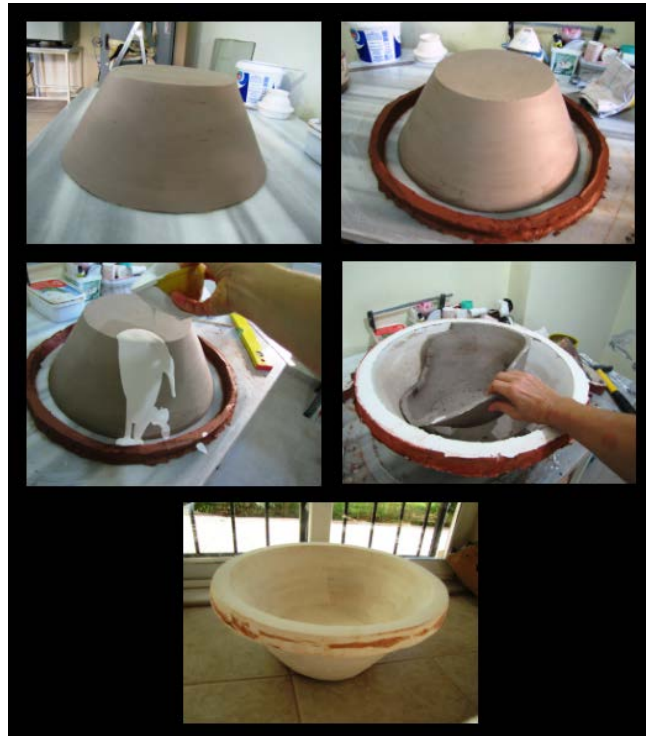
Resim 50 Çanak Kalıbı Yapımı
