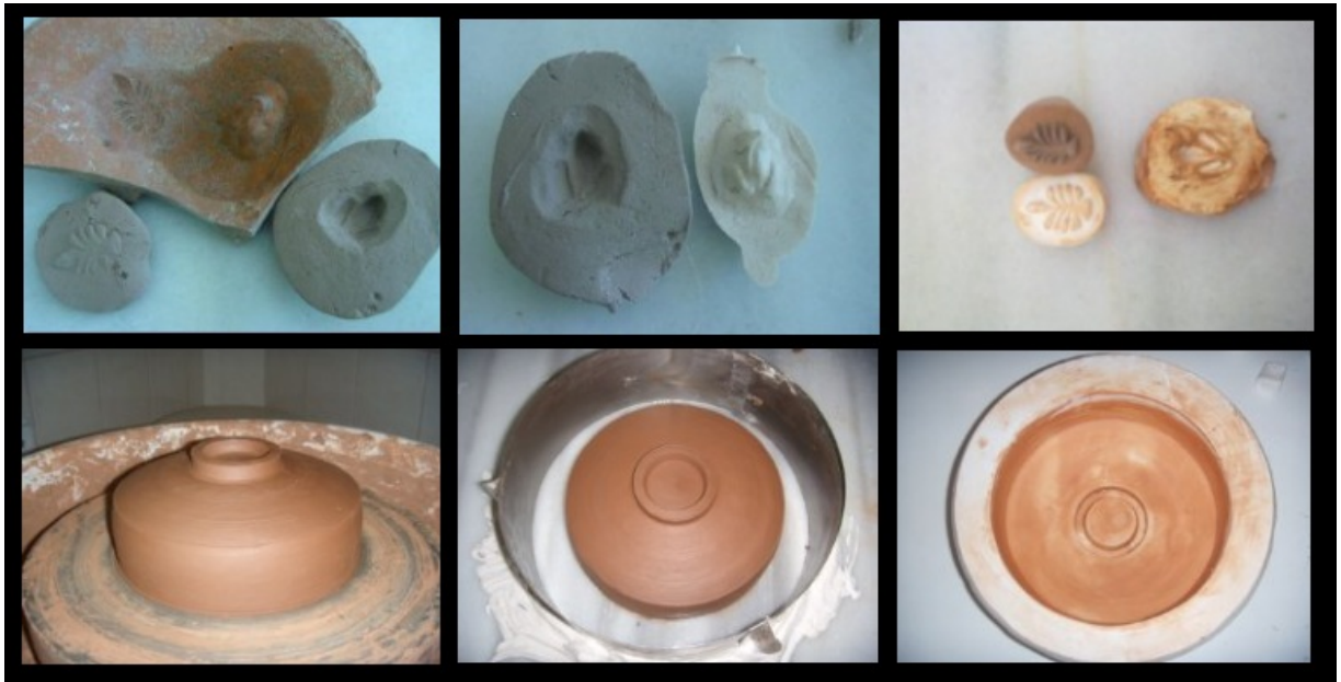
Resim 25 Pi Kulplu Kâse Kalıp Yapımı
