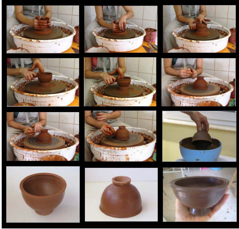
Resim 41 Yuvarlak Gövdeli Kâse Yapımı
