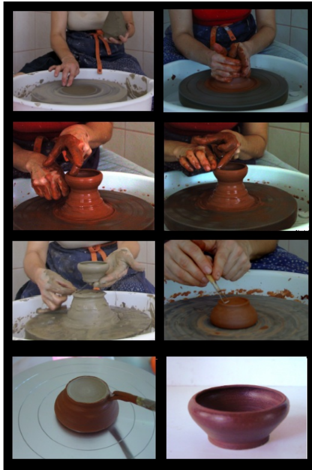
Resim35 İe Dönük Ağızlı Kâse 1 Yapımı
