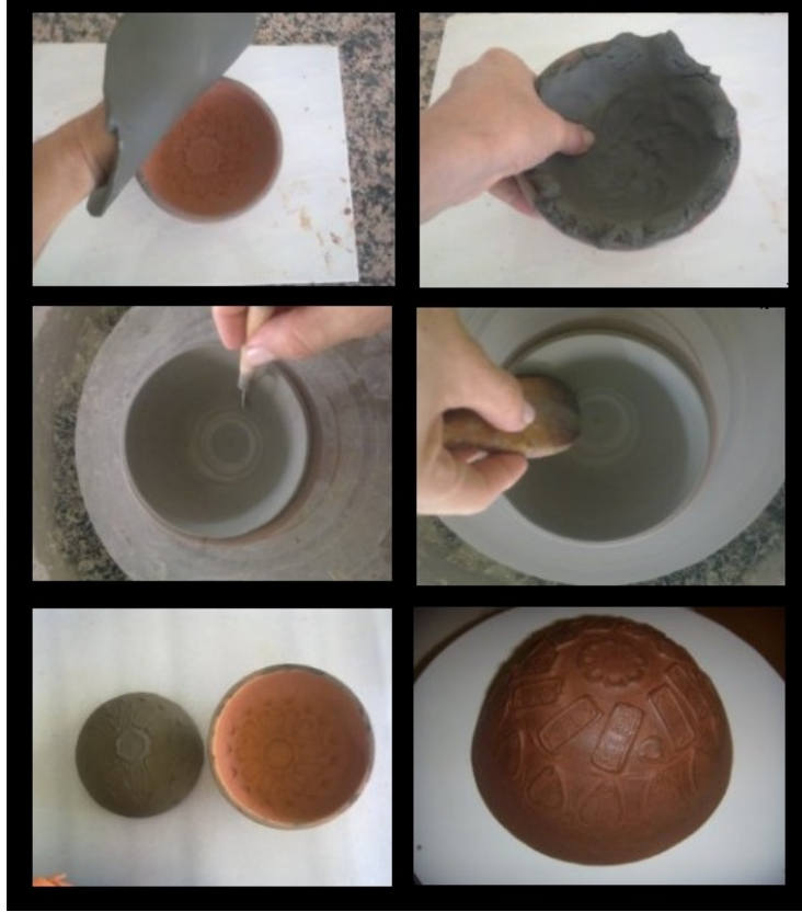
Resim22 Madalyonda Rozet ve Etrafında Geometrik Damga Mühürlü Kâse Üretimi
