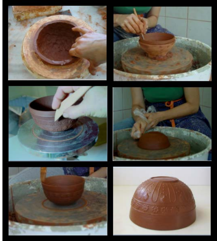
Resim22 Madalyonda Rozet ve Etrafında Geometrik Damga Mühürlü Kâse Üretimi
