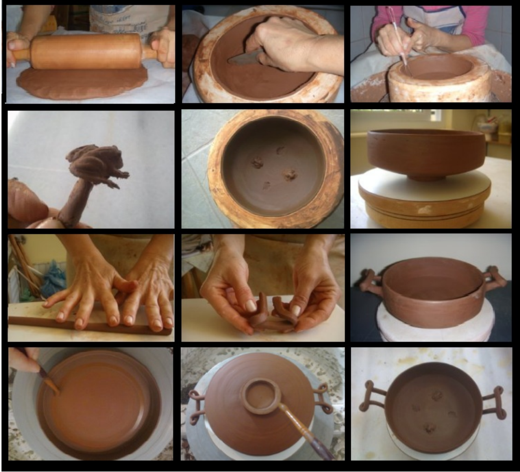
Resim 26 Pi Kulplu Kâse Yapımı
