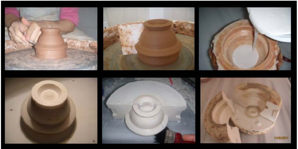
Resim 27 Konik Sigillata Kâse 2 Kalıp Yapımı
