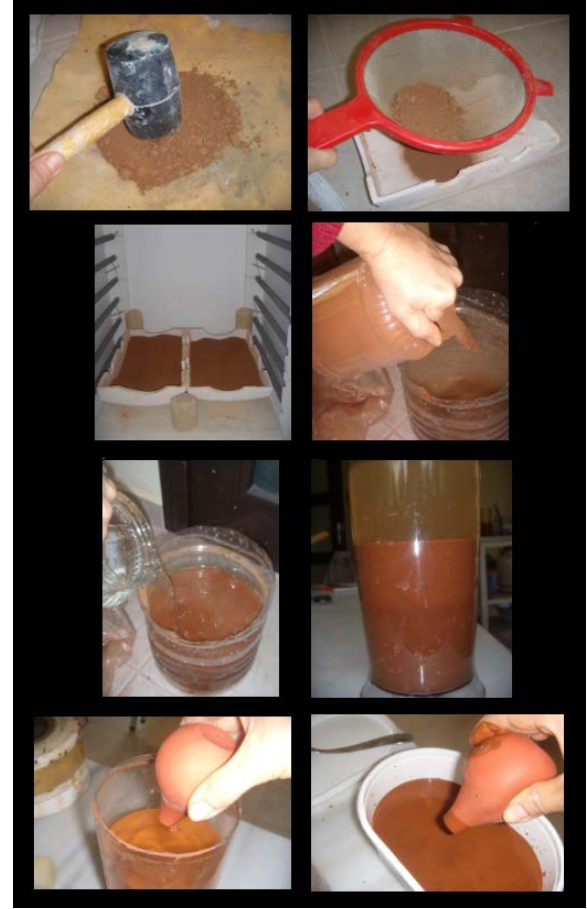
Resim8 Astar Hazırlama ( Terra Sigillata)
