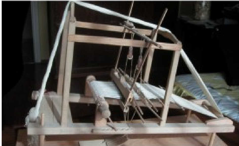
Resim 5: Tarak ve Tefelli Yatay Dokuma Tezgahı
