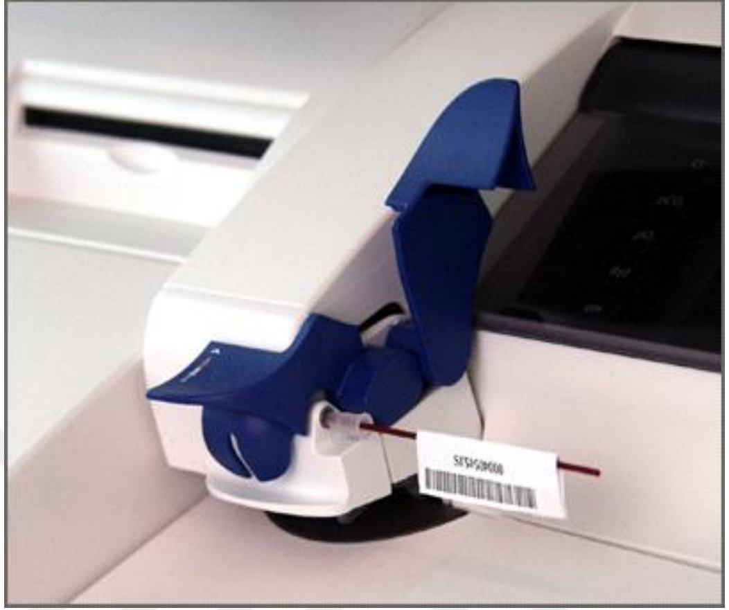
Şekil 3 : ABL 700 (Radiometer, Kopenhag, Danimarka) model kan gazı cihazı ve alınmış kan gazı numunesi.
