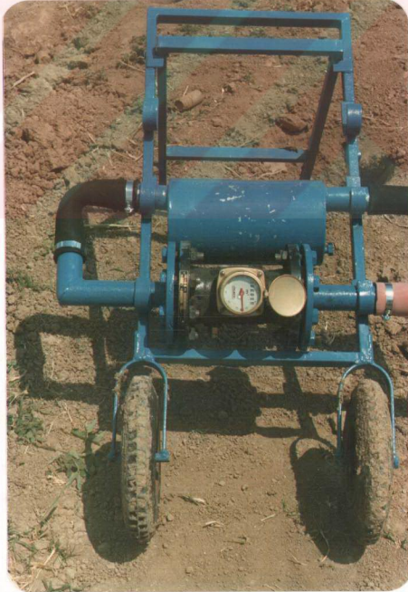
Şekil 3.4 Sulama Ekipmanlarından Filtre-Vana Sistemi
