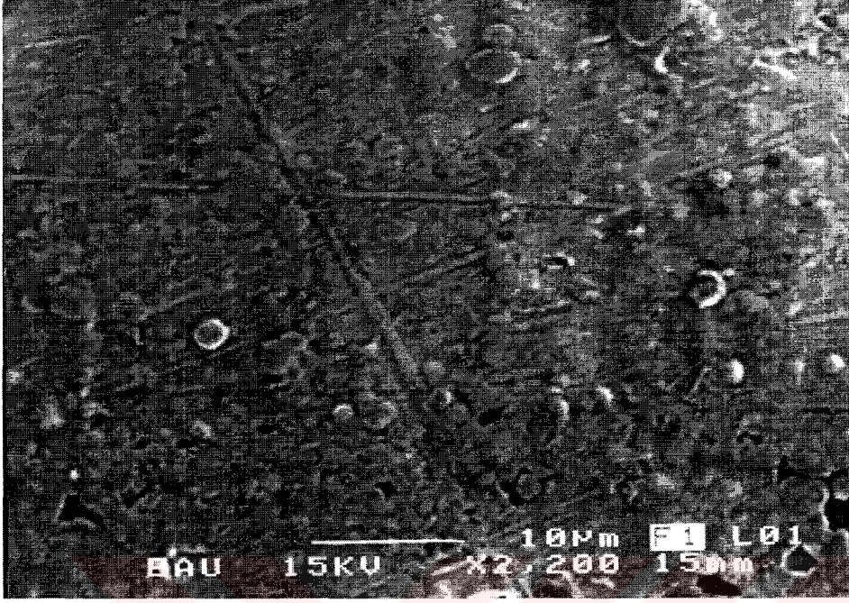
Şekil 4.15. İçerisinde 15 g/l nikel bulunan CuCoNi alaşım filminin SEM resmi
