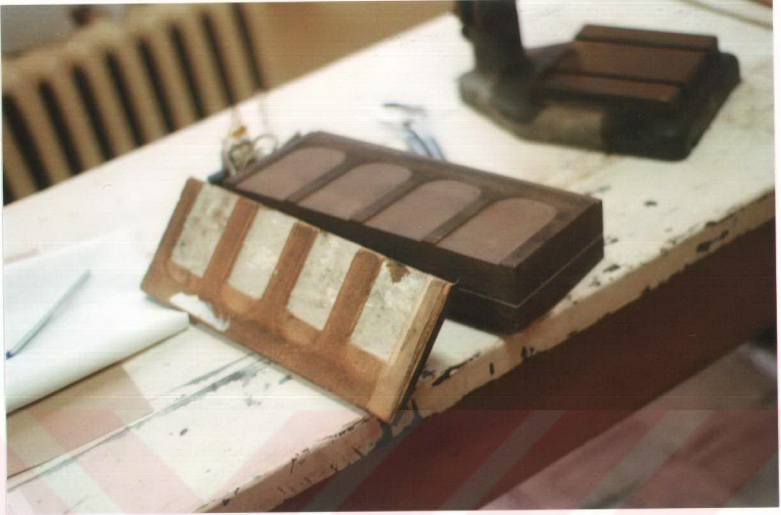
Şekil 3.2.1.1c Özel presin mantar monteli üst aksamının ve termostat bağlı döküm olan alt aksamının sökülmüş durumdaki görünüşleri
