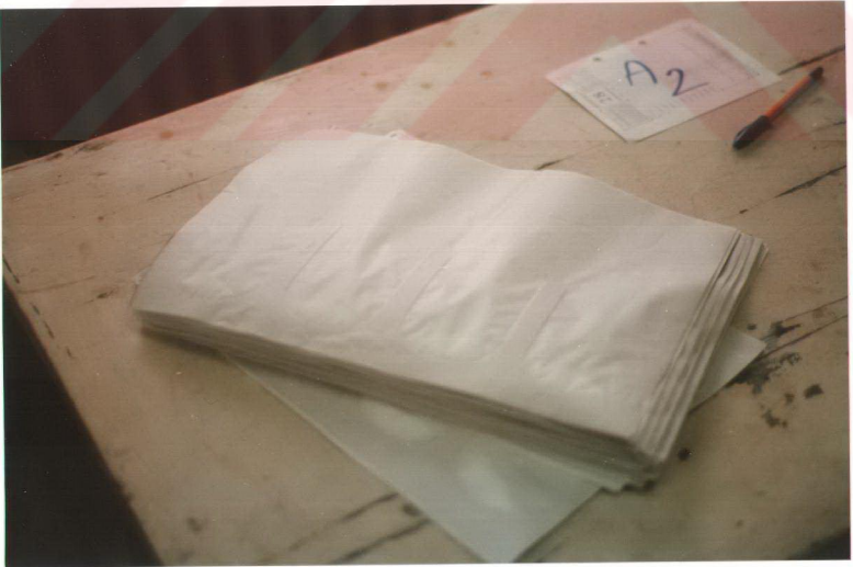
Şekil 3.2.1.2a. 4 adet cebi ısıtma işlemiyle hazırlanmış ve \text{Na}_2\text{S}_2\text{O}_5 konularak kapatılmaya hazır hale gelmiş fumigasyon örtülerinin görünüşleri
