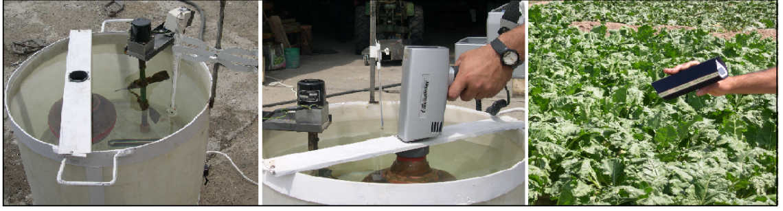
Şekil 3.2 İnfrared termometre kalibrasyon ve şeker pancarı yüzey sıcaklığı ölçümü
