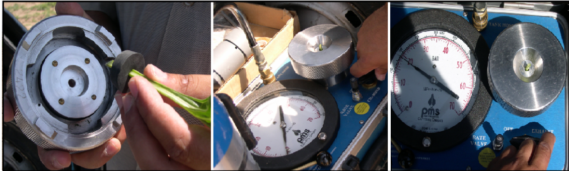
Şekil 3.4 Basınç odası ile şeker pancarı yaprak su potansiyeli ölçümü
