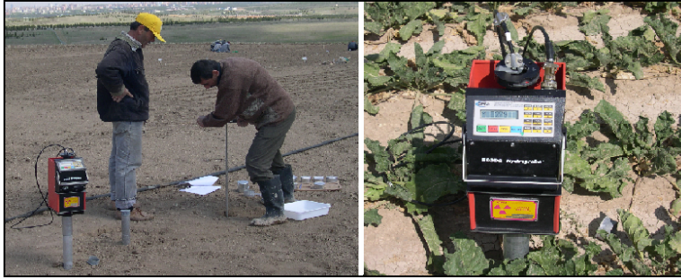
Şekil 3.5 Nötron prob kalibrasyon ve ölçümü
