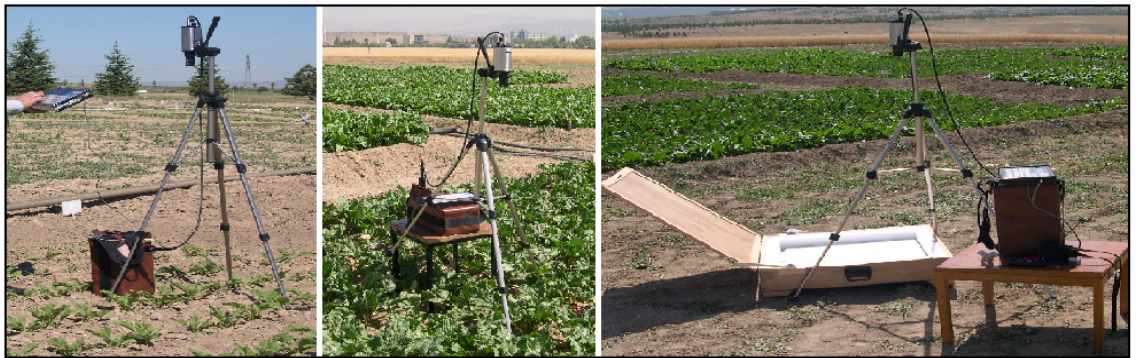
Şekil 3.3 Spektrodymetre ile şeker pancarından ve spektralon plakadan solar radyasyon yansımaları ölçümü
