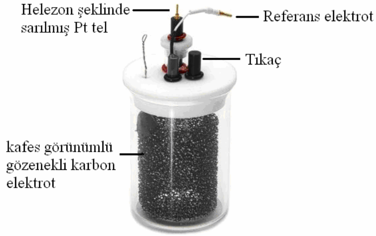
Şekil 3.3 Bioanalytical Systems (BAS) Electrochemical Analyzer BAS 100B cihazına ait sabit potansiyelli kulometri çalışmaları için bulk elektroliz hücresi
