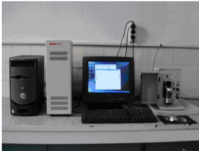
Şekil 3.1 Çalışmanın yapıldığı elektrokimyasal sistem: Bioanalytical Systems (BAS) Electrochemical Analyzer BAS 100B cihazı ve BAS C3 elektrot hücre standı
