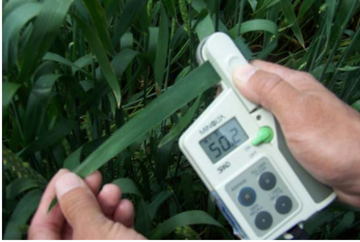
Şekil 3.4 Bayrak yaprakta klorofil içeriğinin ölçümü (SPAD)
