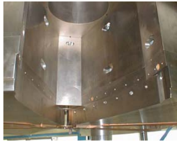
Şekil 2.26 30 MeV'lik bir siklotronun Dee boşluğu
