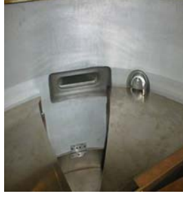
Şekil.2.29 30 MeV'lik bir siklotronun demet çıkış noktası
