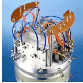
Şekil 2.23 30 MeV'lik bir siklotronun iyon kaynağı sistemi (Harici Multicusp)
