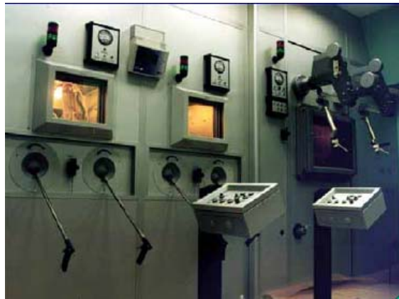
Şekil 4.2 NTP'deki (G.Afrika) tipik bir sıcak hücre (Hot-Cell)
