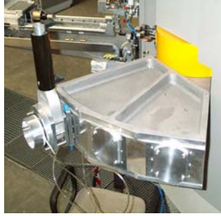
Şekil 2.30 30 MeV'lik bir siklotronun ayırıcı (stripping) mıknatısı
