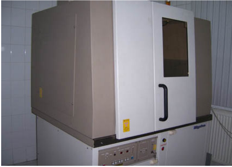
Şekil 8.1 X-Işını Kırınım Sistemi Rigaku D/Max- 2200/PC
