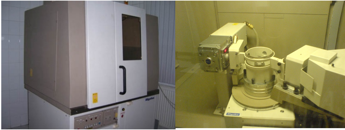
Şekil 3.3 Rigaku D-max 2200 marka x-ışını cihazı ve gonyometre
