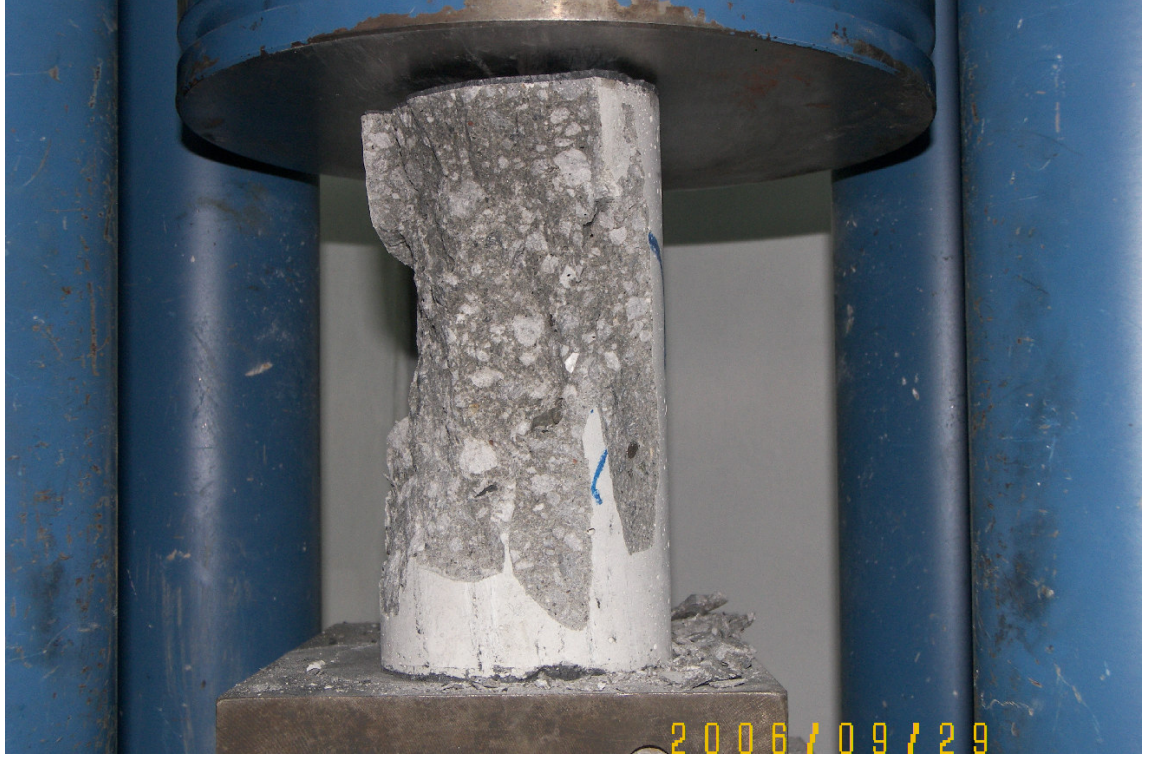
Şekil 3.5.1. Betonun basınç dayanımının belirlenmesi
