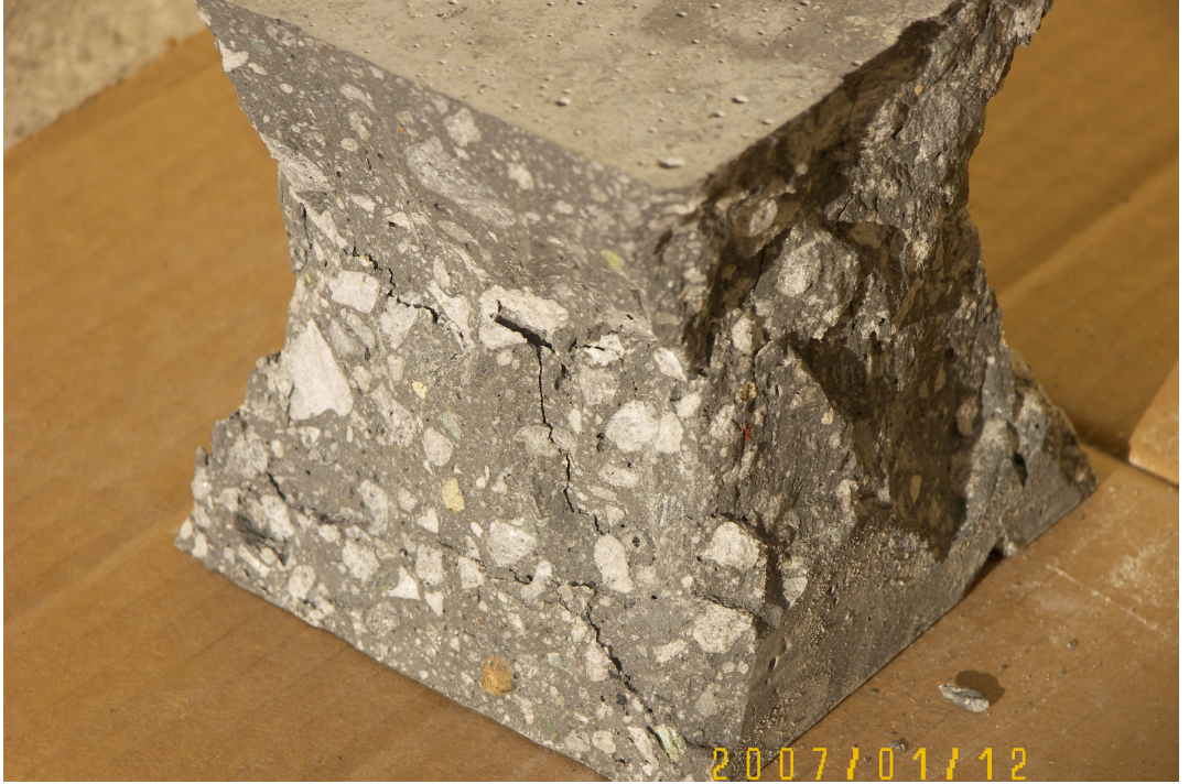
Şekil 4.1.1. İri perlit agregasının basınç dayanım testi sırasında kırılması
