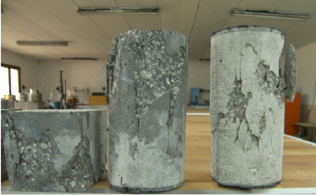
Şekil 4.4.1.5. Lif katkıli betonların basınç yükü altında kırılma şekilleri
