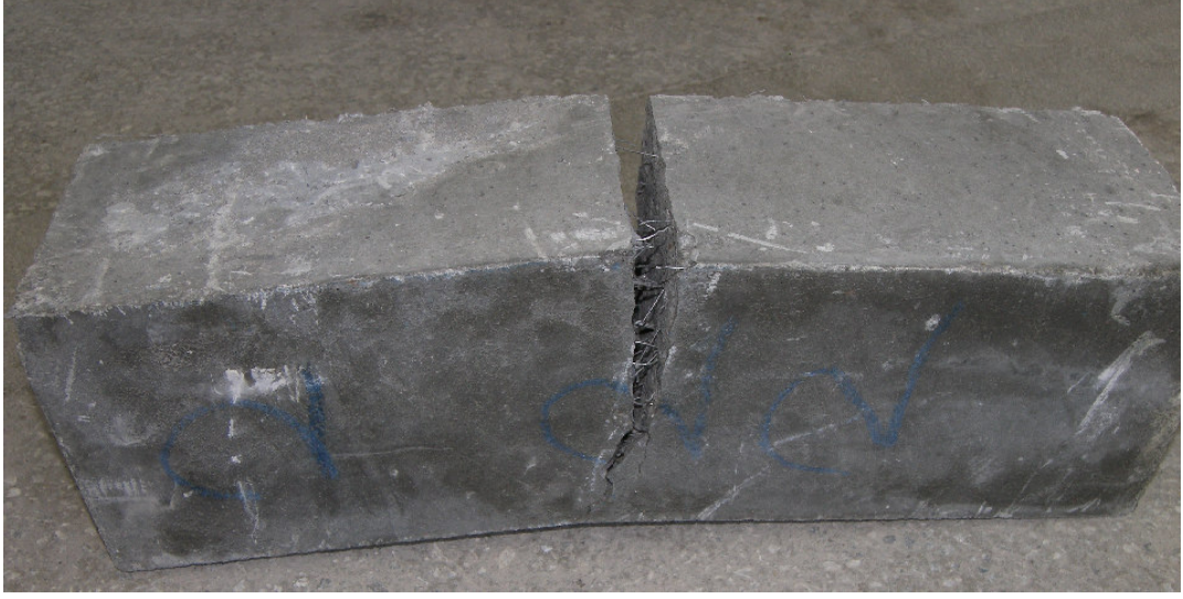
Şekil 4.4.4.5. Lifli betonda eğilmede çekme dayanım deneyi sonrası görünüm
