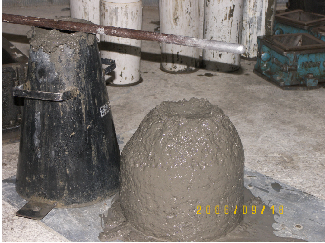
Şekil 4.2.2. Lifli betonun çökme biçimi
