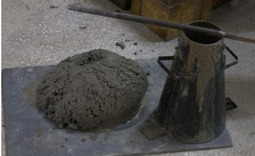
Şekil 3.6.3.1. Beton kıvamının çökme deneyi ile belirlenmesi
