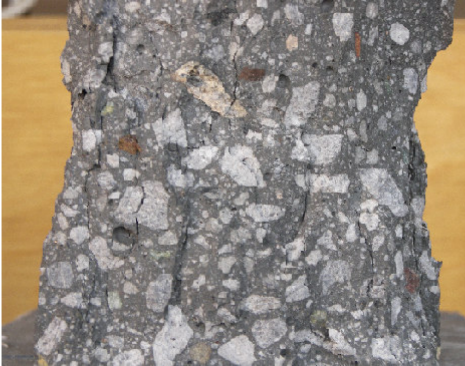
Şekil 4.4.1.4. Basınç dayanım testi sonrası perlit agregalı hafif betonda görünüm
