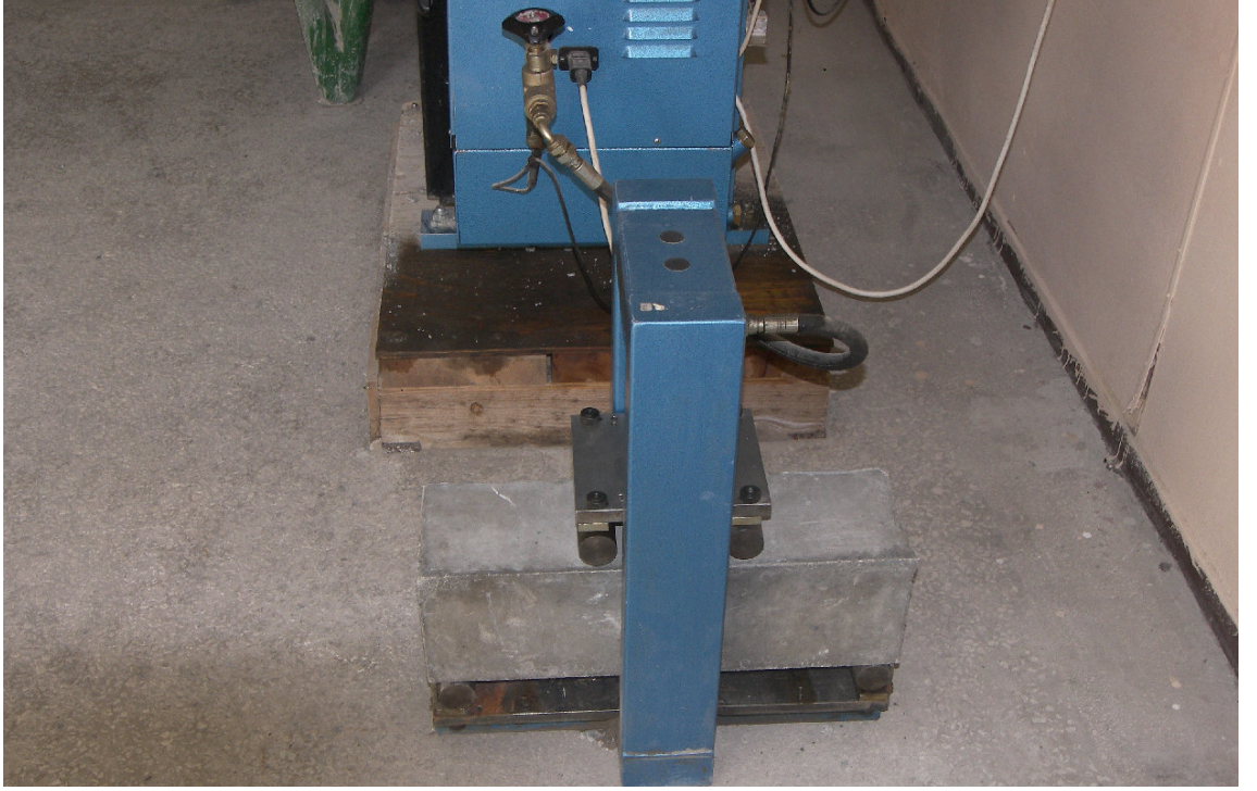
Şekil 3.5.3. Betonun eğilmede çekme dayanımının belirlenmesi
