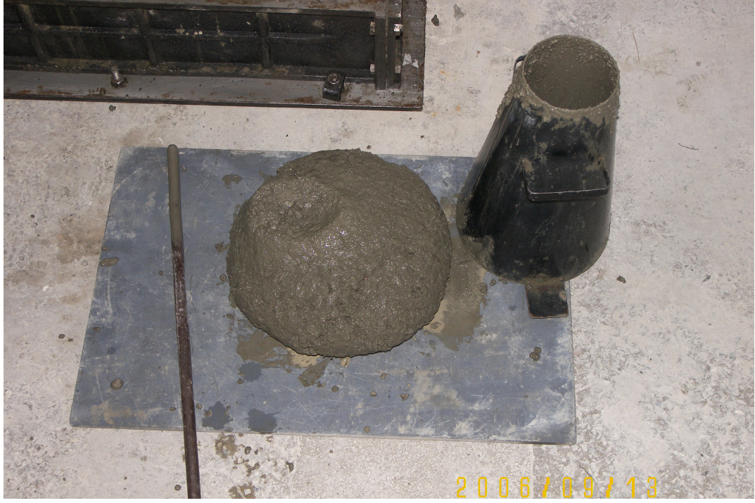
Şekil 4.2.1. Katkısız betonun çökme biçimi
