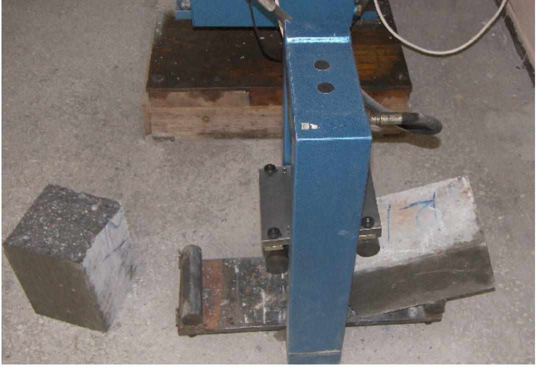
Şekil 4.4.4.4. Lifsiz betonda eğilmede çekme dayanım deneyi sonrası görünüm
