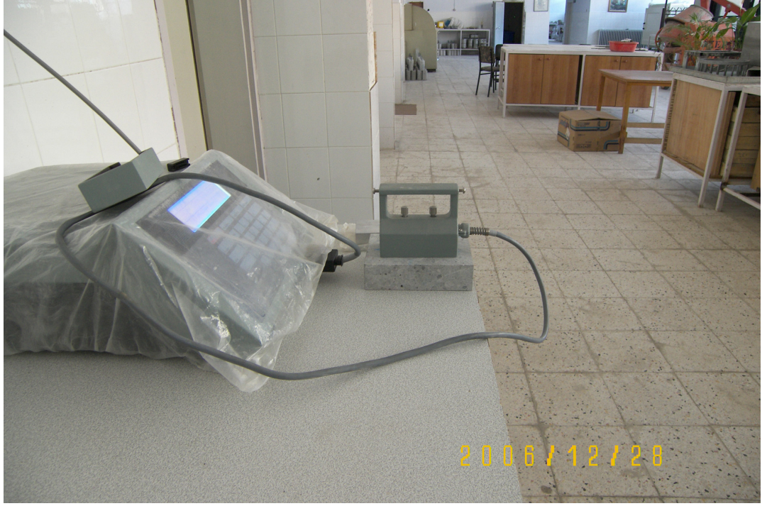
Şekil 3.6.7.1. Sıcak tel yöntemiyle ısı iletkenliğinin belirlenmesi
