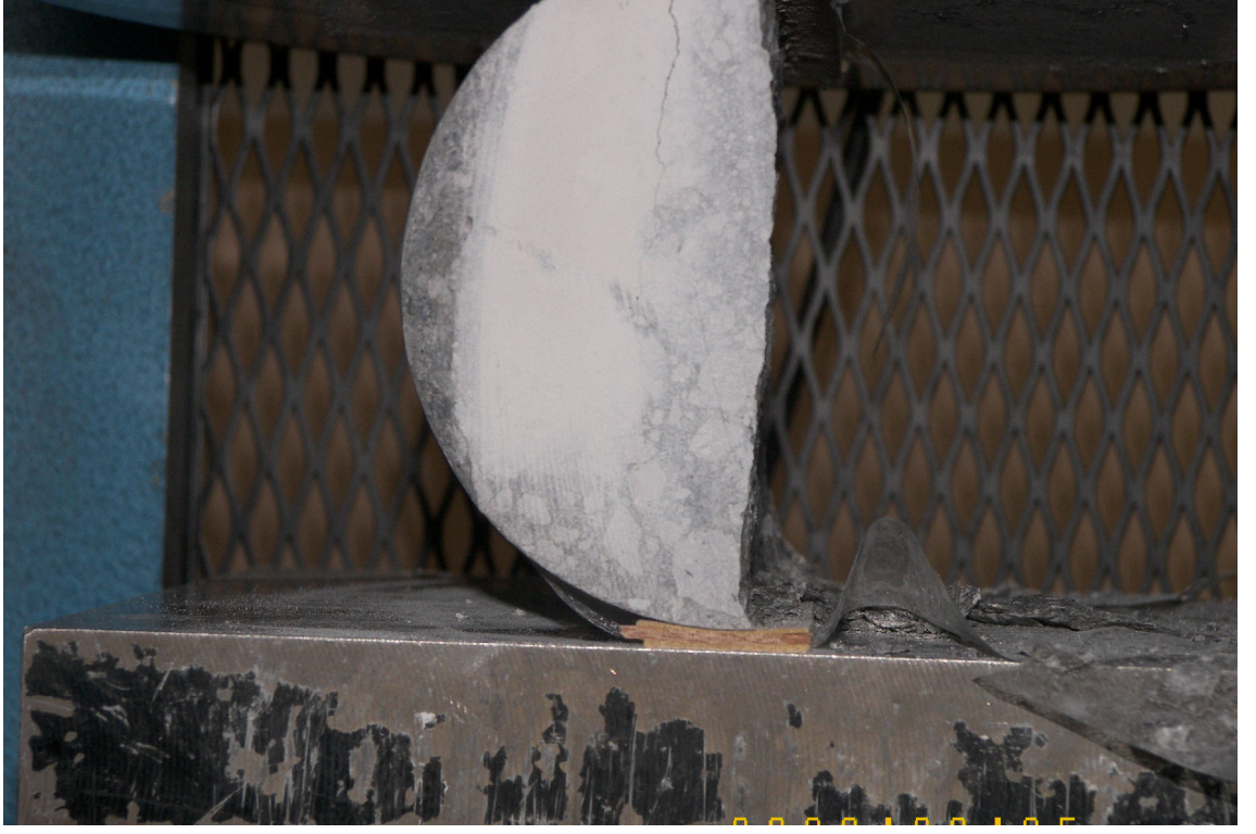
Şekil 3.5.2. Betonun yarmada çekme dayanımının belirlenmesi
