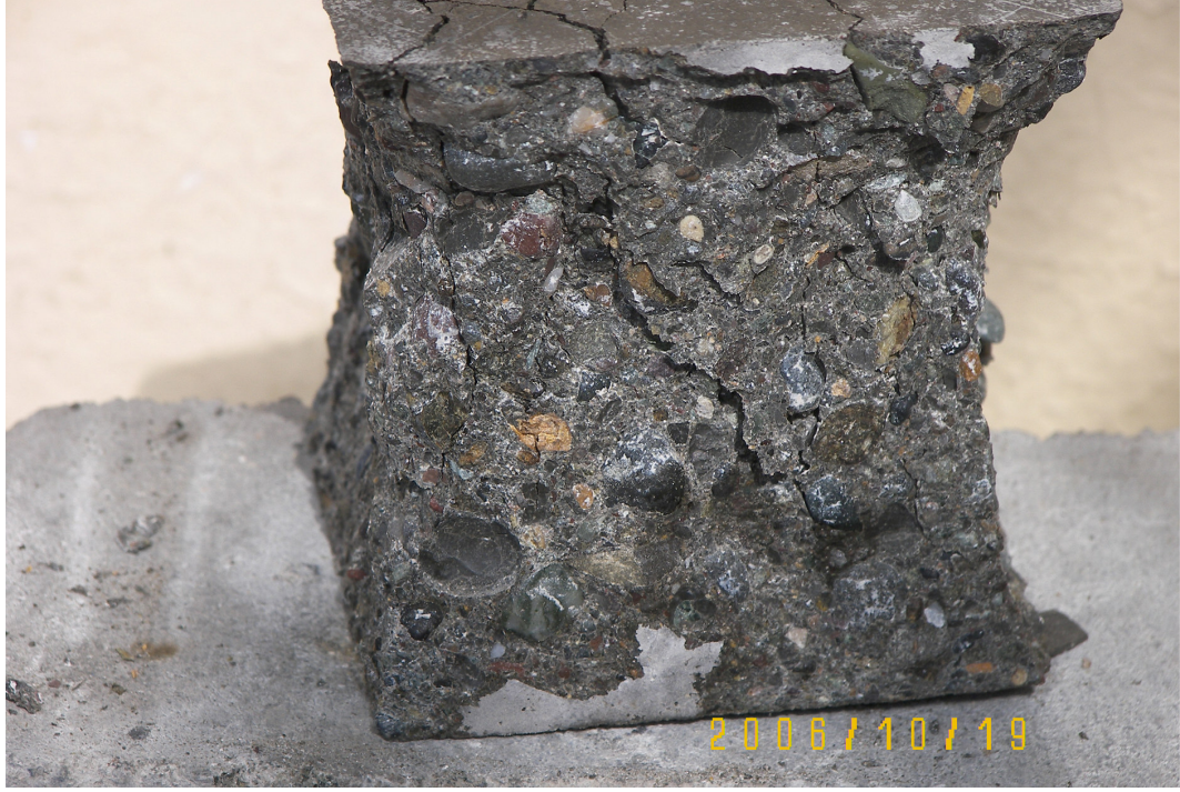
Şekil 4.4.1.2. Normal agregalı betonda (Kontrol betonu) basınç dayanım testi sonrası görünüm
