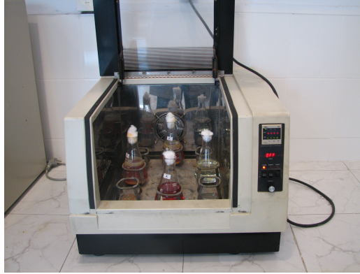
Şekil 3.1. Bakteri izolasyon deneylerinde kullanılan inkübatör
