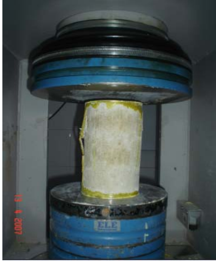
Şekil 4.19. Borojips ilaveli numunelerin kükürtle başlıklanıp prese girmiş hali
