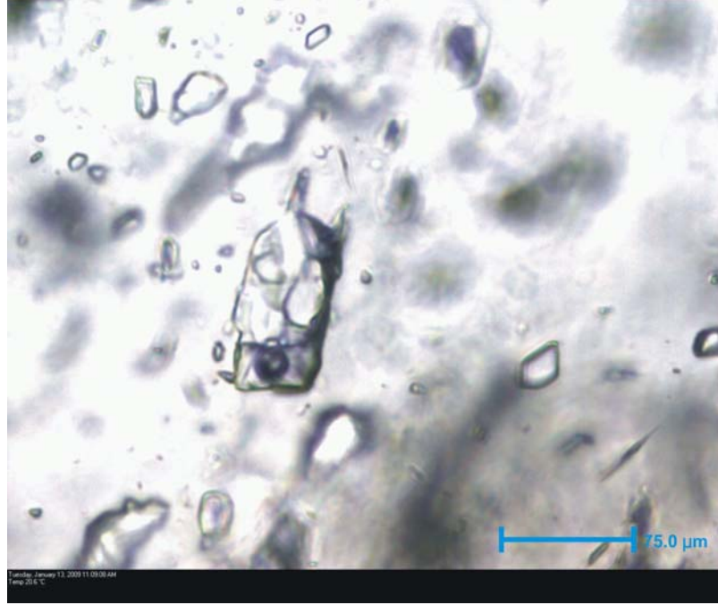
Şekil 5.75 SSa-3 örneğinde tek fazlı (sıvı) + iki fazlı (sıvı+gaz) kapanımlar
