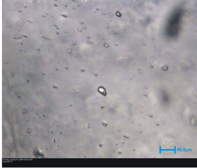
Şekil 5.72 SSa-2b örneğinde iki fazlı (sıvı+gaz) kapanımlar ile tek fazlı (sıvı) kapanımlar
