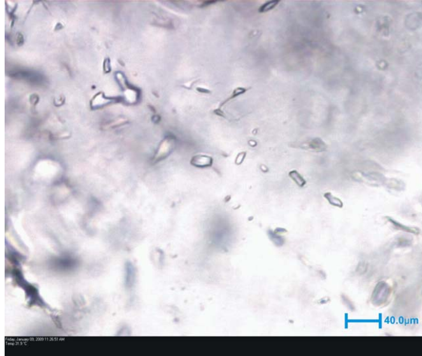
Şekil 5.78 SSa-4 örneğinde tek fazlı (sıvı) kapanımlar
