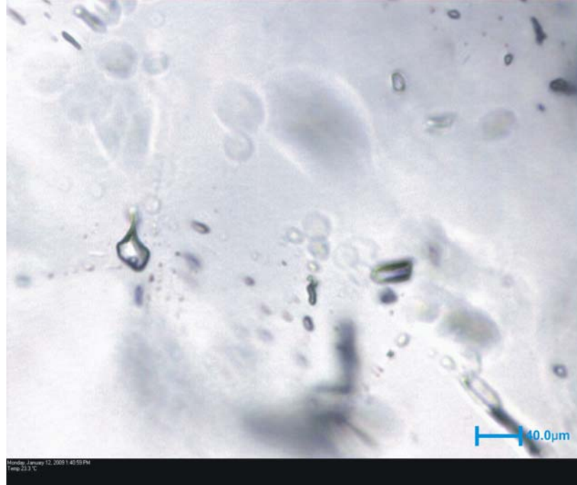
Şekil 5.82 SSa-4 örneğinde iki fazlı (sıvı+gaz) kapanım ve tek fazlı (sıvı) kapanımlar
