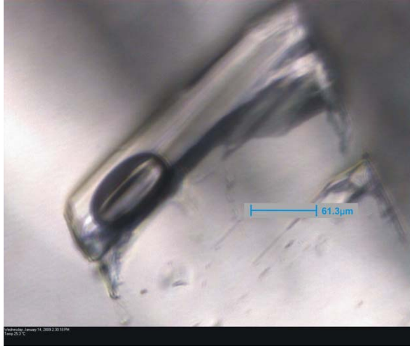
Şekil 5.73 SSa-2a örneğinin şeffaf kesiminde oldukça iri iki fazlı (sıvı+gaz) kapanım
