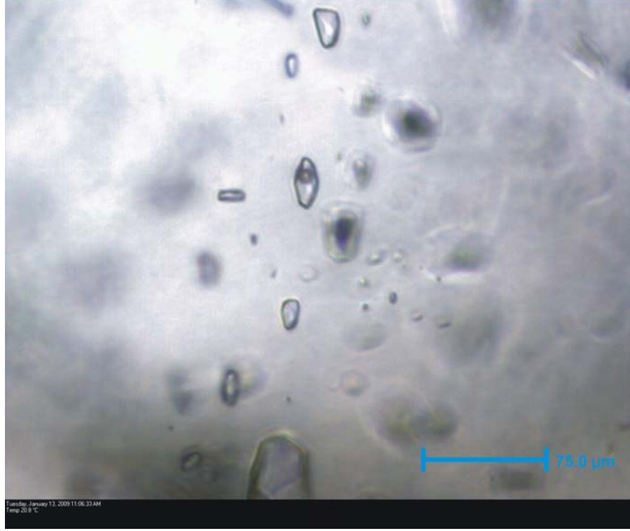
Şekil 5.74 SSa-3 örneğinde bol miktarda tek fazlı (sıvı) kapanımlar ile iki fazlı (sıvı+gaz) kapanımlar
