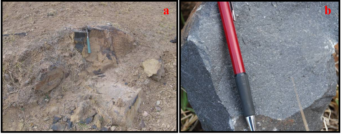
Şekil 5.57.a. Ojit andezit-II kayacının sahadaki görünümü, b. Afanitik dokulu, plajiyoklaz fenokristalleri içeren kayacın yakından görüntüsü
