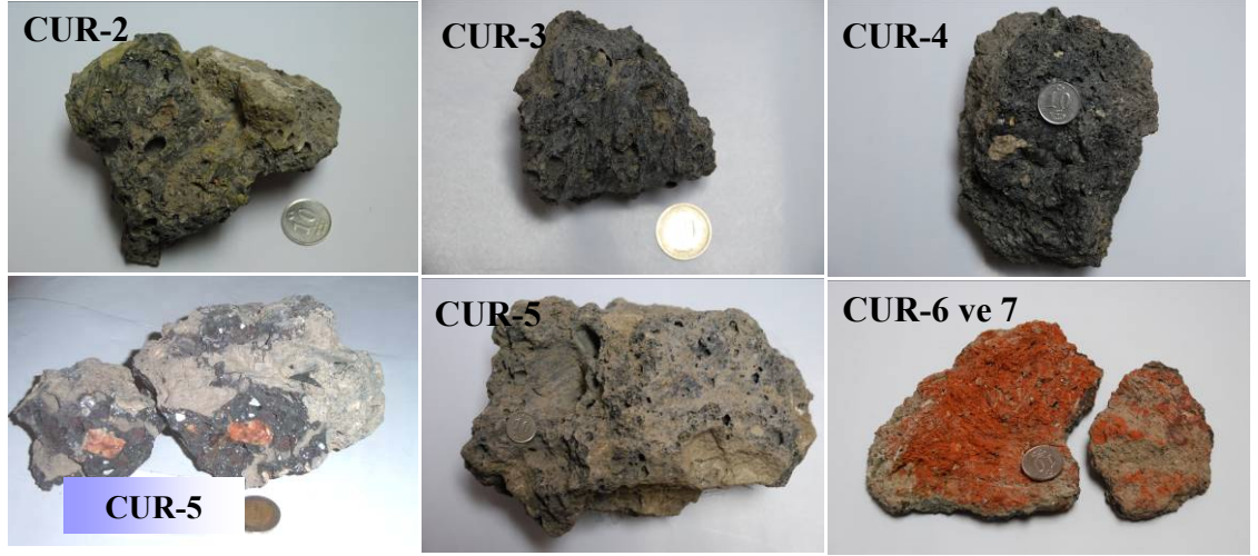
Şekil 10.28 Analizi yapılan bazı curuf örneklerinin fotoğrafları
