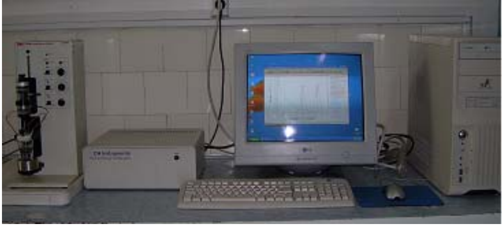
Şekil 3.1 CH Instruments Electrochemical Workstation CHI760B ve BAS CGME Hücre Standı
