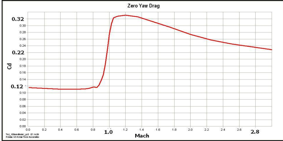
Şekil 7.2 Prodas ile hesaplanan C_{d0} grafiği
