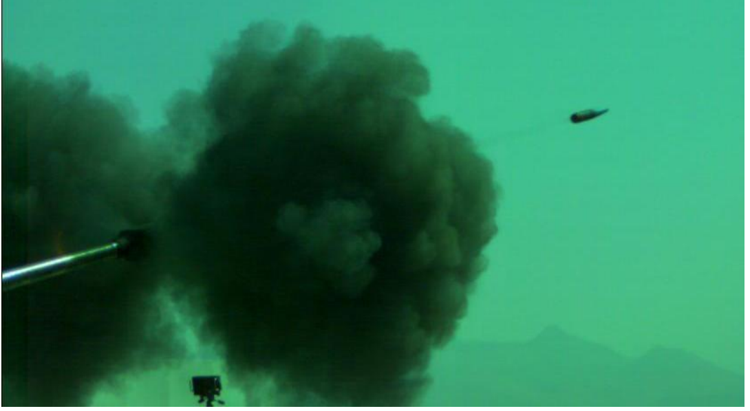
Şekil 7.3 Top mermisinin namlu çıkışındaki hızlı kamera görüntüsü
