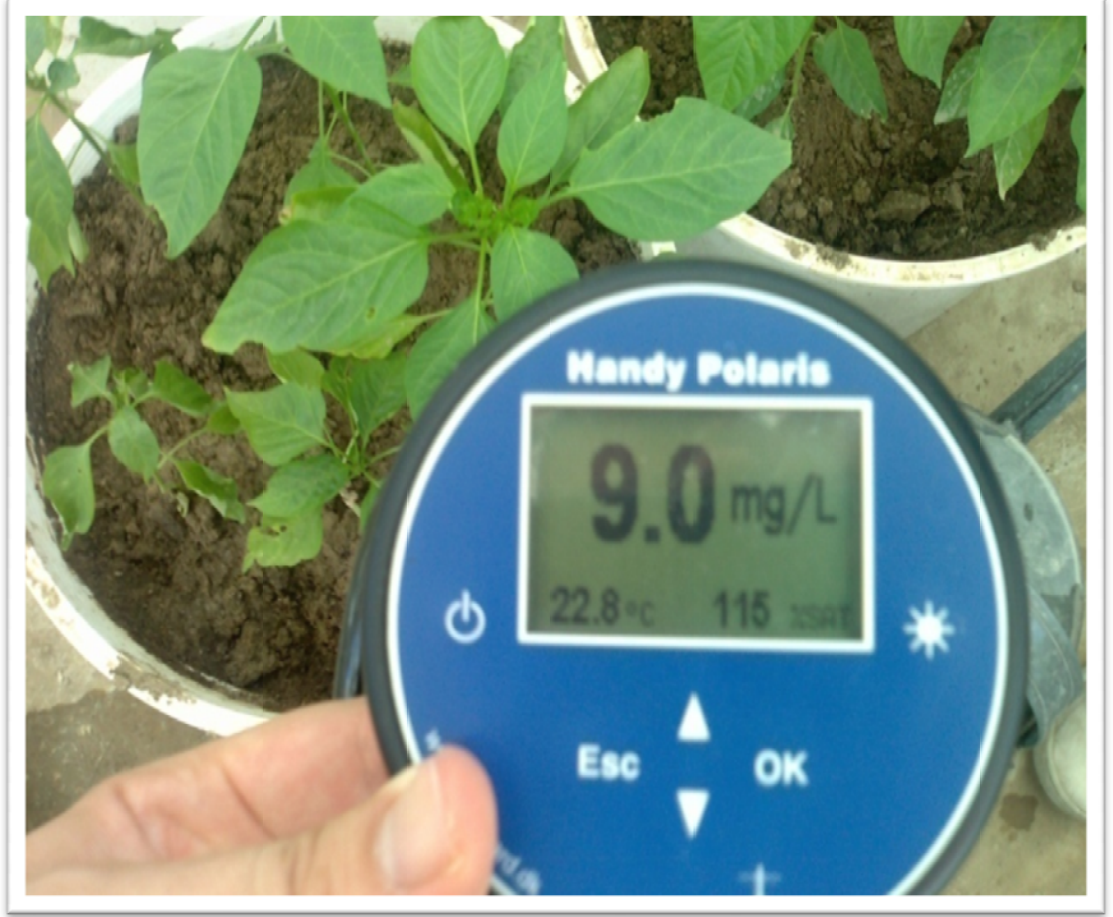
Şekil 3. 5 Sulama sularının oksijenmetre ile oksijen düzeylerinin belirlenmesi
