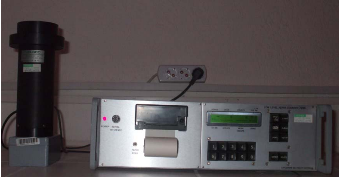
Şekil3.8 ELSEC 7286 düşük seviye alfa sayıcısı ve PM tüpü
