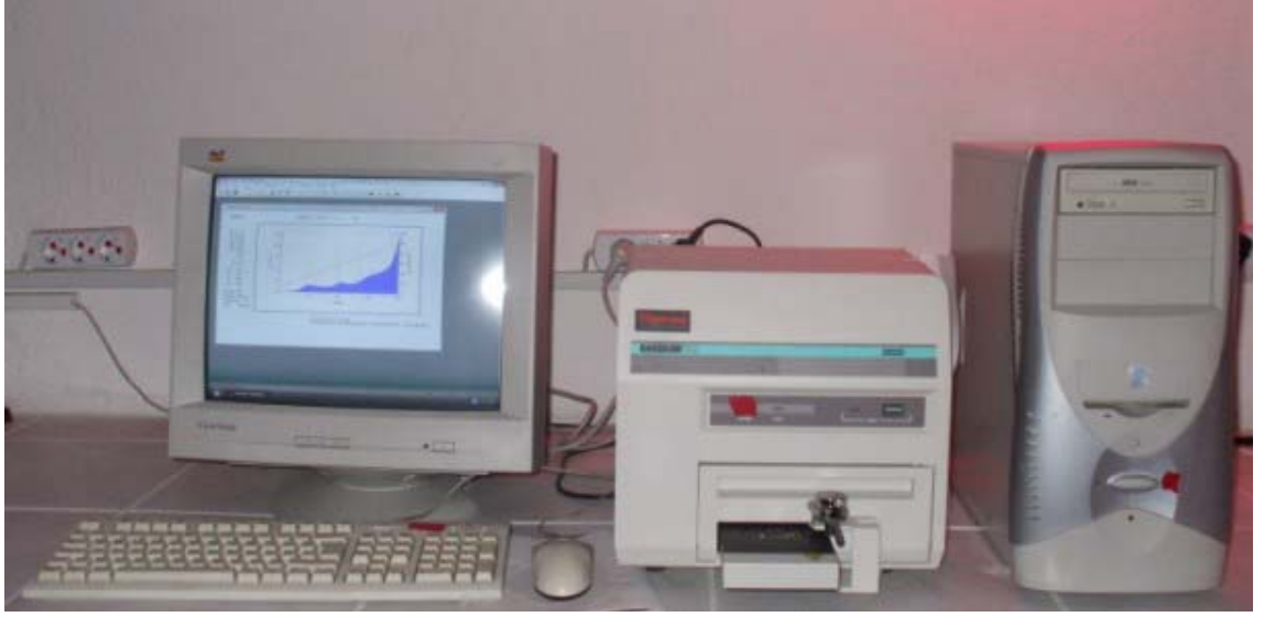
Şekil 3.5 Harshaw 3500 TLD okuyucu
