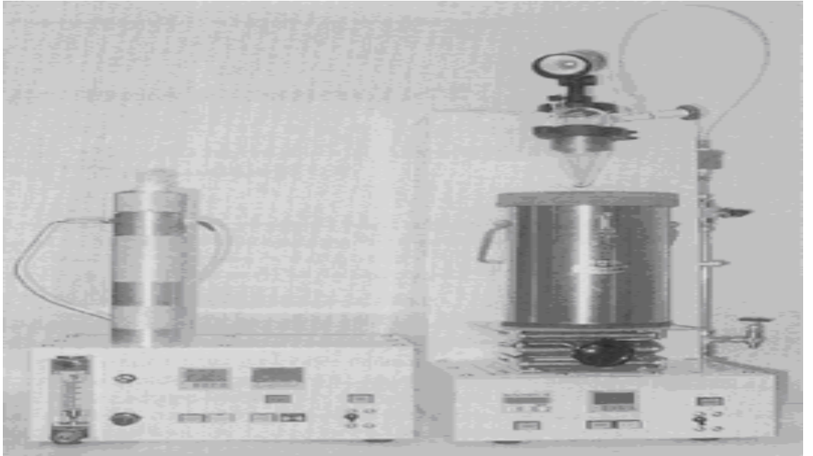
Şekil 3.1 [^{18}\text{O}]\text{H}_2\text{O} saflaştırıcı. UV ışınlama ünitesi (solda), damıtma ünitesi (sağda) (Kitano vd. 2001)
