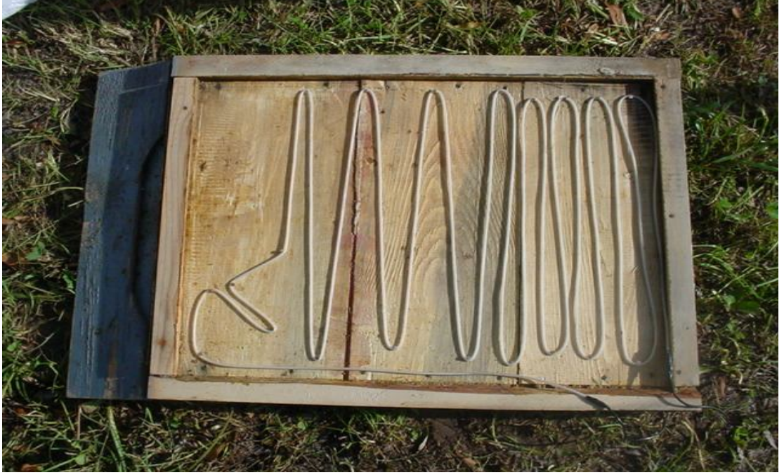
Şekil 3.3. Ahşap kovanlarda kullanılan ısıtıcı rezistansın tabana yerleştirilmesi
