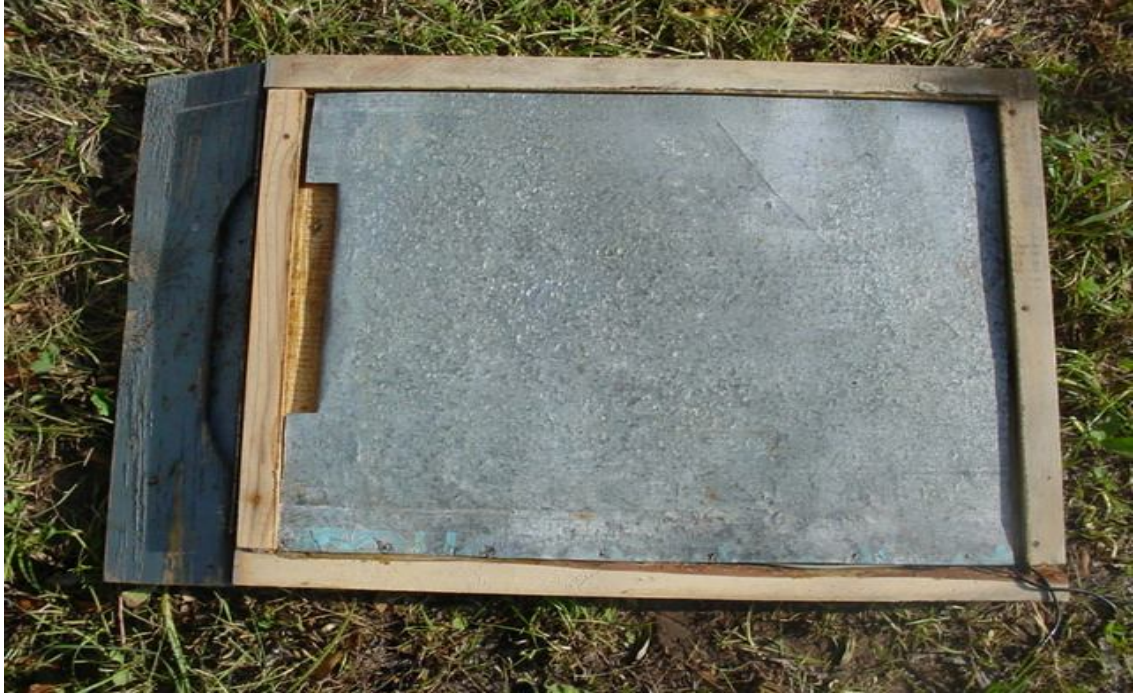
Şekil 3.6. Isıtıcı rezistanstan oluşabilecek manyetik alanın önlenmesi için tellerin üzerine yerleştirilip topraklama yapılan galvanize sac
