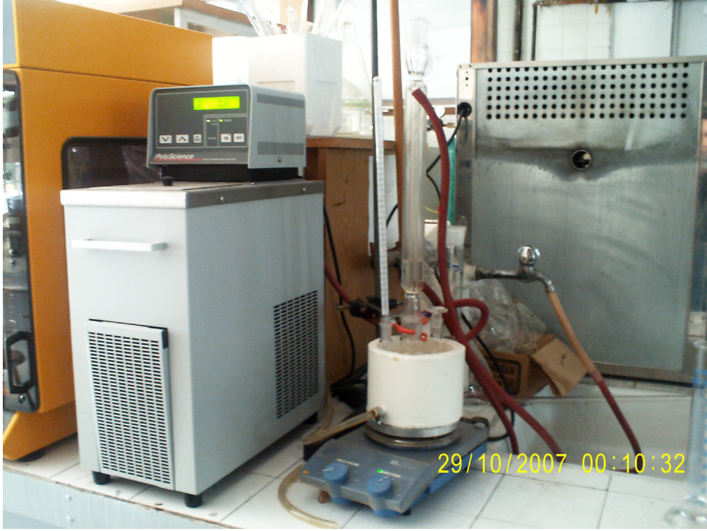
Şekil 3.1 Trimetil kitosan sentezinde kullanılan deney sistemi
