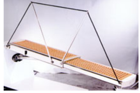
Şekil 1.4: Tekne kıç aynasına montajlı teleskopik paserellanın açık konumu
