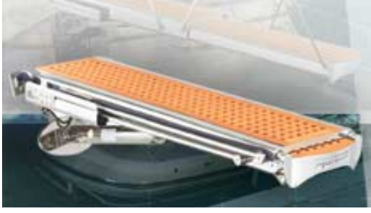
Şekil 1.3: Tekne kıç aynasına montajlı teleskopik paserellanın kapalı konumu
