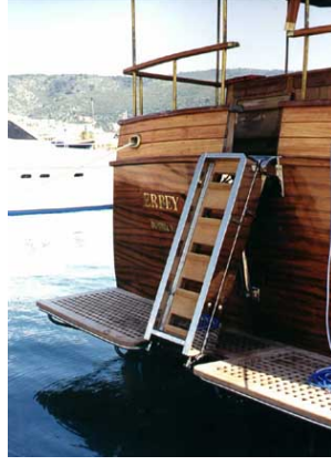
Şekil 1.5: Tekne kıç aynasına montajlı katlanır tip paserella
