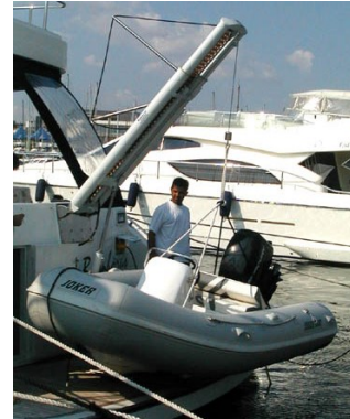
Şekil 1.13: Yük kaldırmada kullanılan paserellanın yük kaldırma durumu
