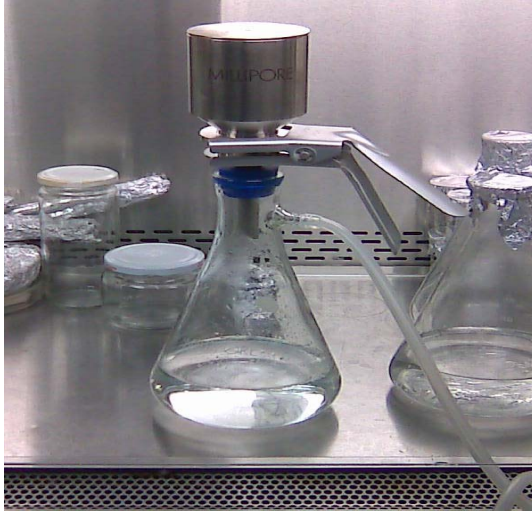
Şekil 3.6 Filtrasyon ünitesi ve kabin içinde besin ortamının sterilizasyonunun yapılışı
