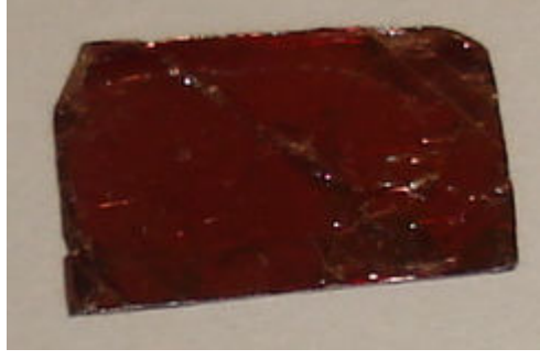
Şekil 3.5 Tabakalı GaSe kristalinden bir kesit (foto, 2010)
