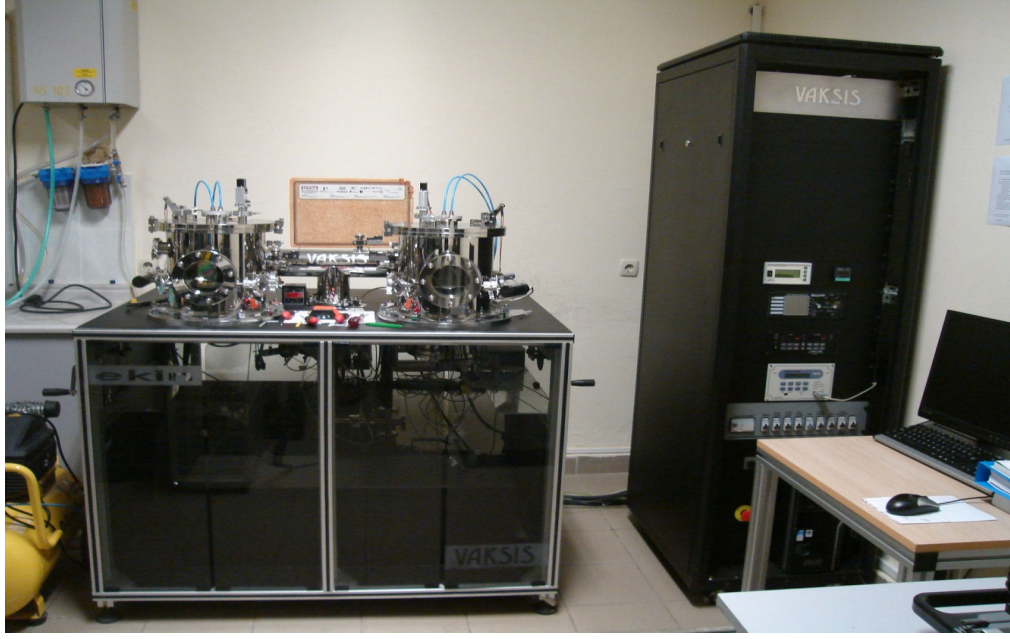
Şekil 3.6 Vakum altında ısıl buharlaştırma sistemi (foto, 2010)
