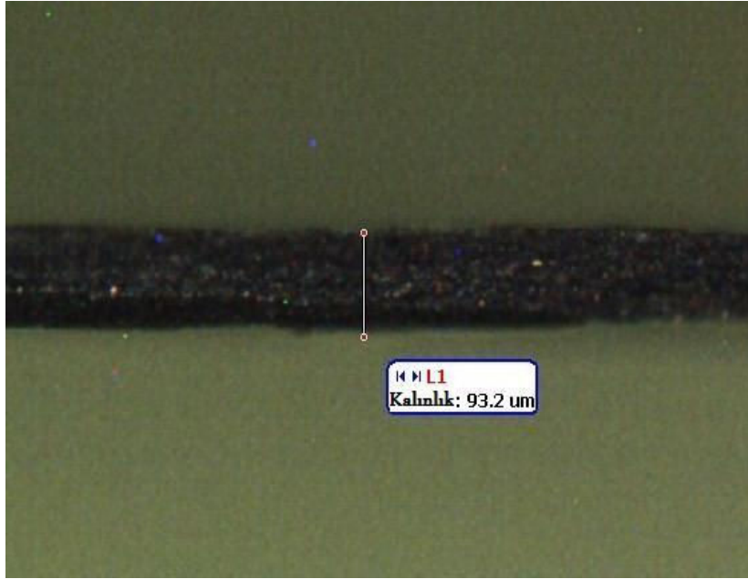
Şekil 4.4 GaSe:Sn külçe kristalinin optik mikroskoptan elde edilen kalınlığı
