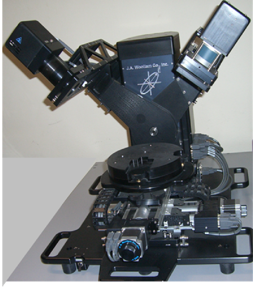
Őekil 3.10 Spektroskopik elipsometre (Woollam,-M2000V foto, 2010)
