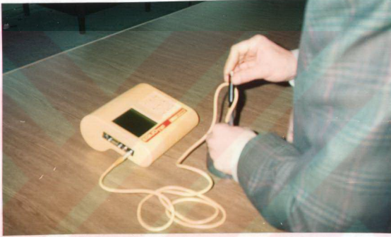
Şekil 7. Digital, Seyyar Sertlik Ölçme Cihazında Yapılan Sertlik Ölçme İşlemi
