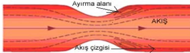
Şekil 2.7. Akımı ters çeviren bölgelerin ve akış yönünde hızlı bir genişlemeyi izleyen bir daralmanın şematik gösterimi
