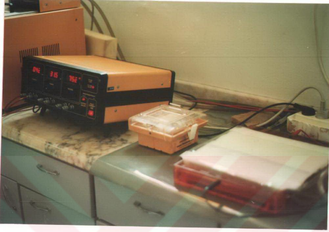
Fotoğraf 3. 5. Elektroforez cihazı ve buna bağlı PAG kalıbı
