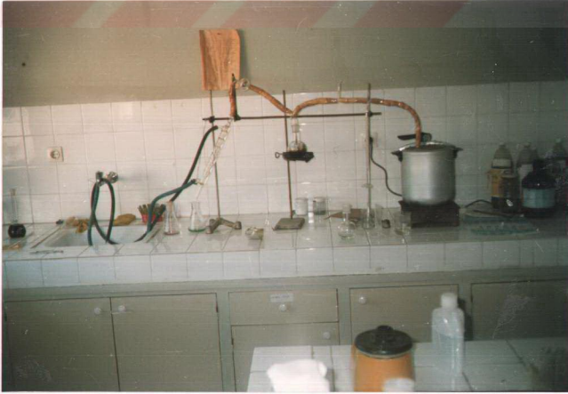
Fotoğraf 3.7 Protein analizlerinde kullanılan kjeldahl cihazı.
