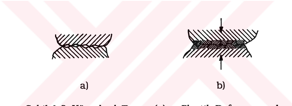
Şekil-1.3. Yüzeylerde Temas (a) ve Plastik Deformasyonlar (b). (Gediktaş, 1970)
