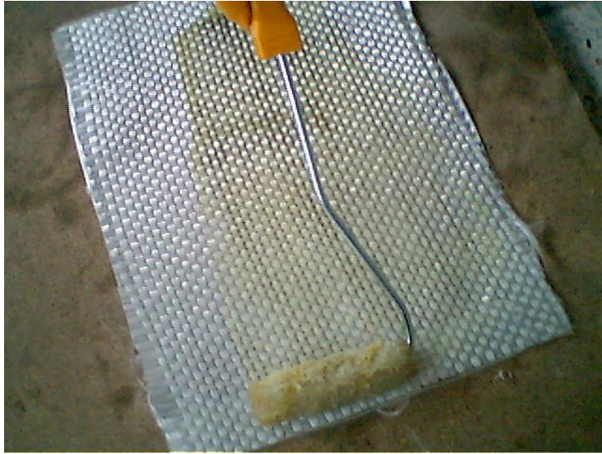
Şekil 3.7. Cam elyafın reçineye doyurulması
