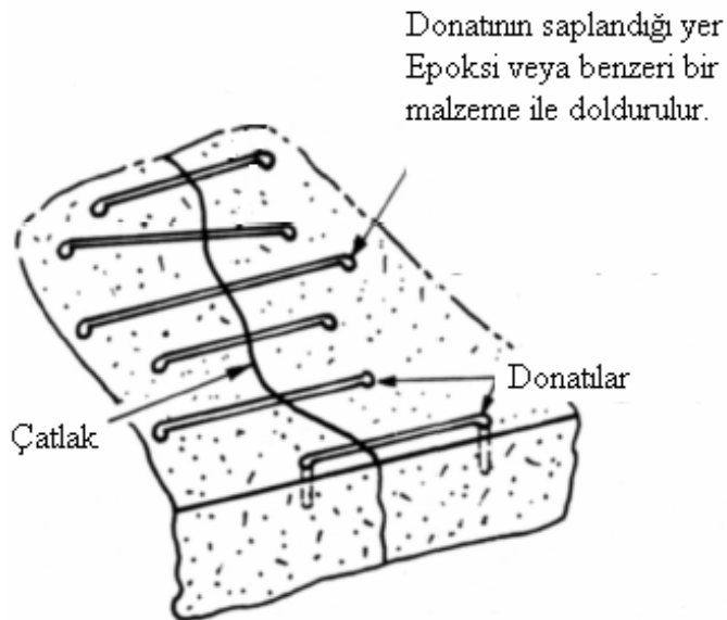
Şekil 1.2. Çatlakların donatılarla tutturulması
