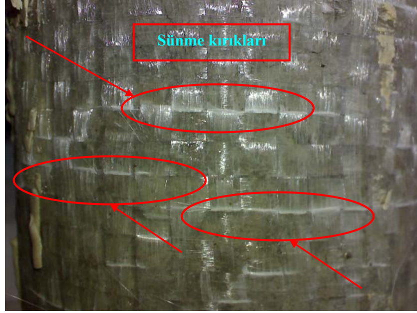
Şekil 4.17. GFRP uygulanmış numunelerde gerçekleşen sünme kırılması
