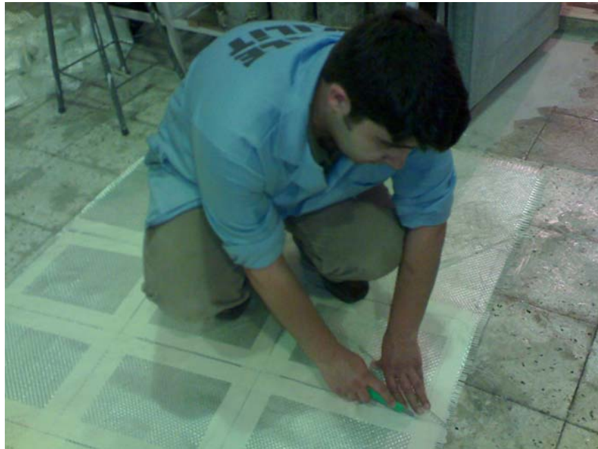
Şekil 3.5. Cam elyaf dokumanın kesilerek hazırlanması
