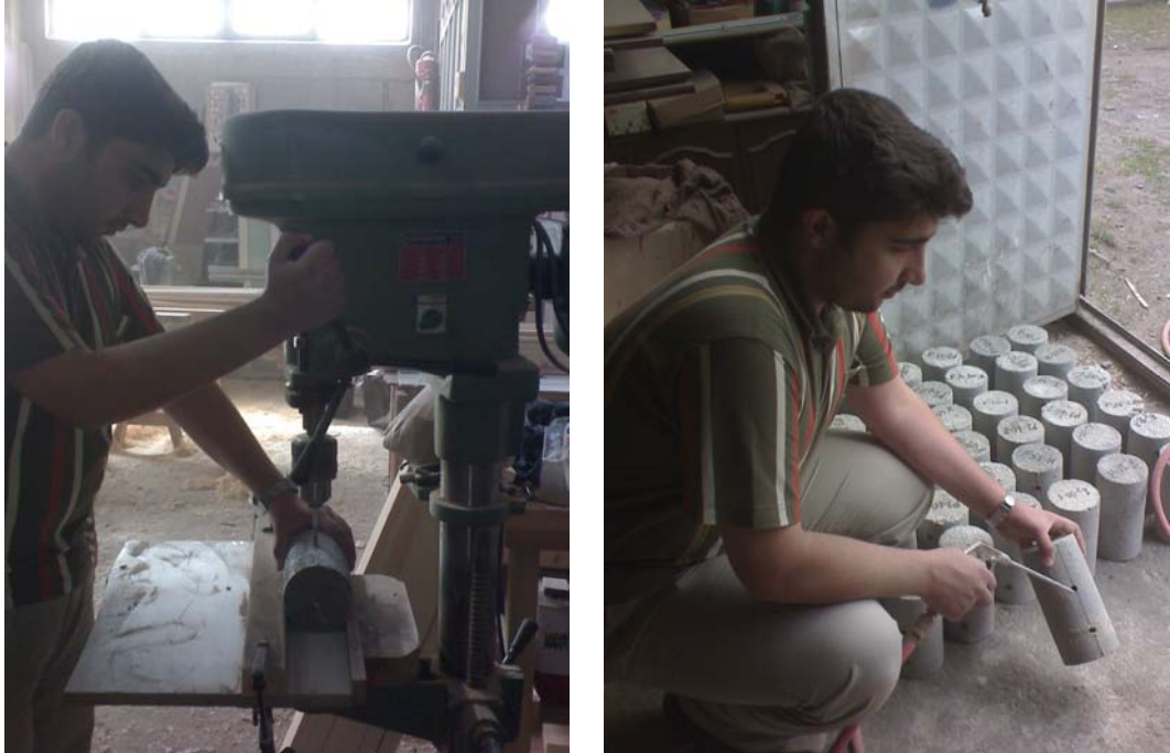
Şekil 3.12. Numunelerin delinmesi ve kompresör ile temizlenmesi
