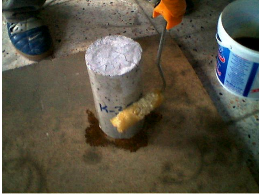
Şekil 3.6. Reçinenin beton yüzeyine tatbiki
