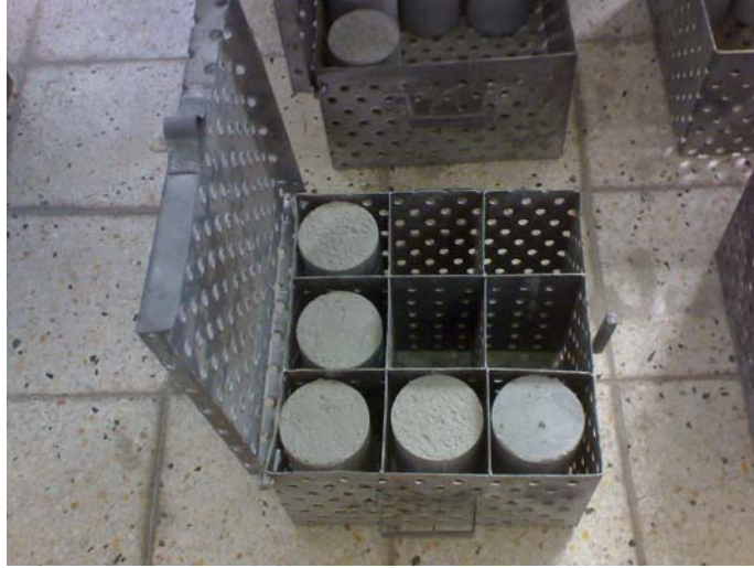
Şekil 3.4. Çelik kutular içine yerleştirilmiş beton numuneler
