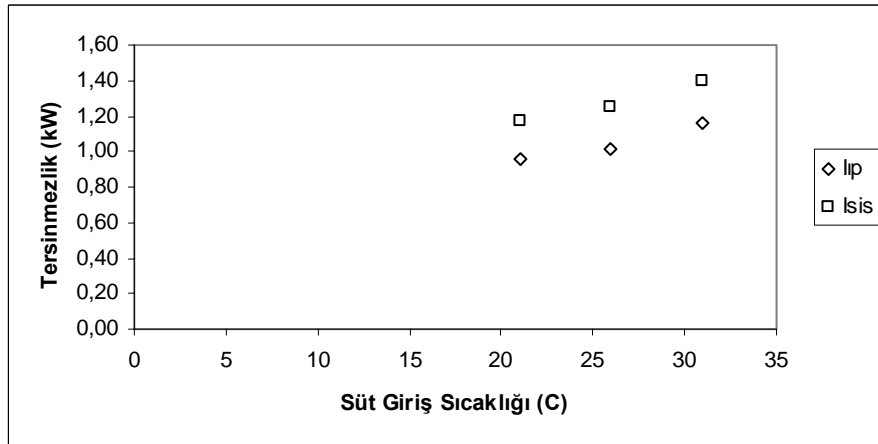
Şekil 4.47. R134a soğutkanı için, 21°C, 26°C ve 31°C süt giriş sıcaklıklarında ve 4 l/dk sabit süt debisinde ısı pompası ve sisteminin tersinmezlik değerlerinin değişimi
